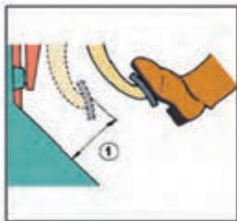
شکل ۱۶- بازدید فاصله پدال ترمز تا کف
