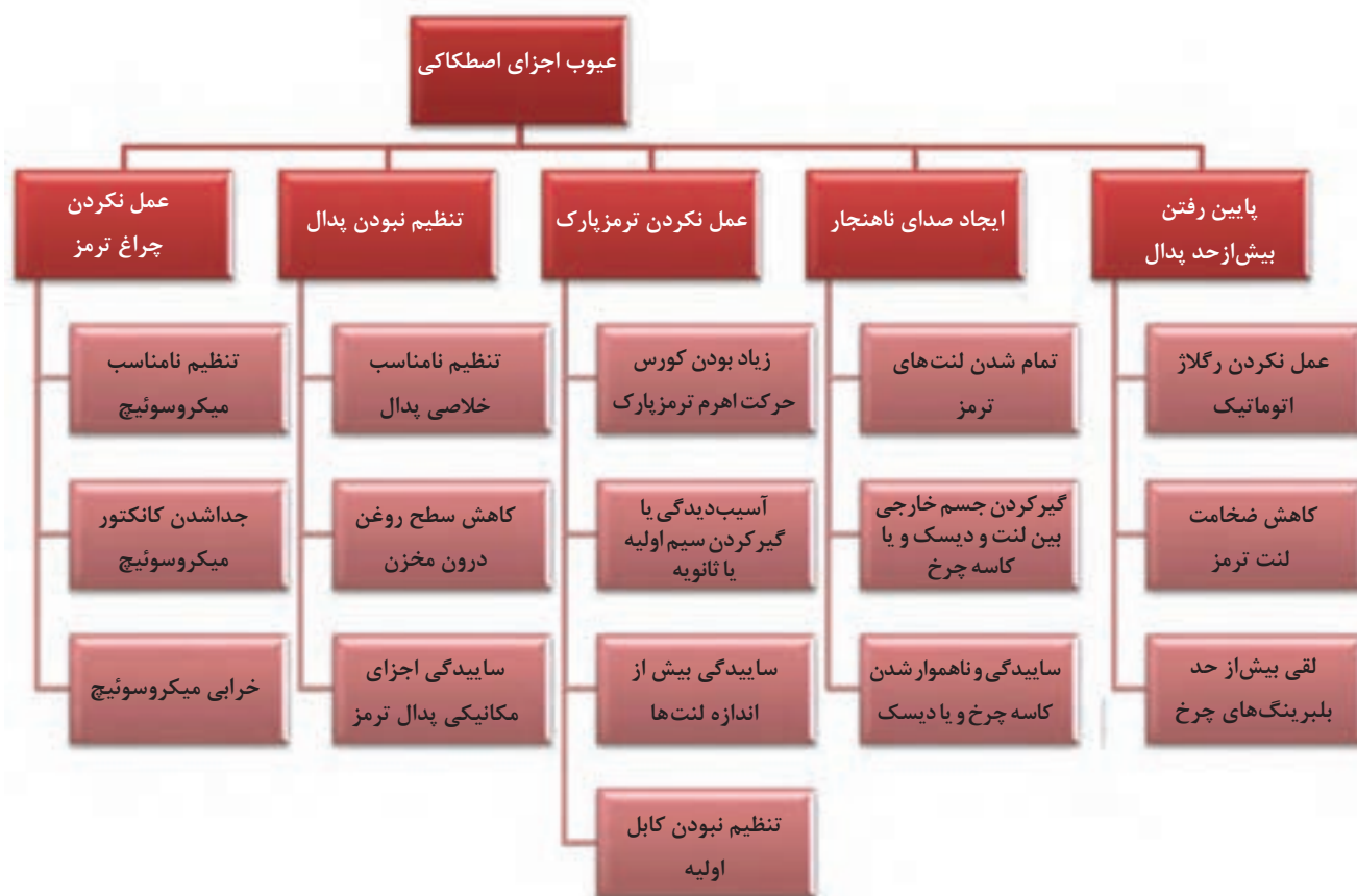
شکل ۲۳- عیوب اجزای اصطکاکی
