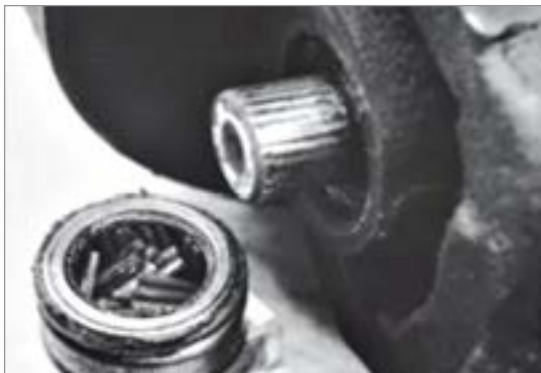
شکل ۲۳-۳- بررسی ساچمه سوزنی
