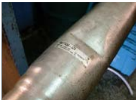
شکل ۱۵-۳ مشاهده آثار ضربه روی سطح میل گاردان
