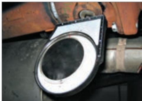
شکل ۱۳-۳ روش استفاده از زاویه سنج میل گاردان
