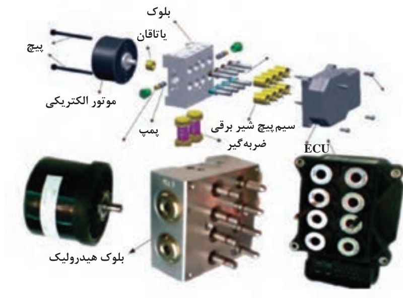
شکل ۴۸- بلوک هیدرولیک سیستم ترمز ضد قفل
