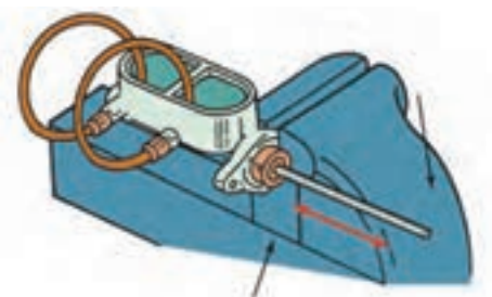
شکل ۳۰- روش هواگیری قبل از بستن روی خودرو
