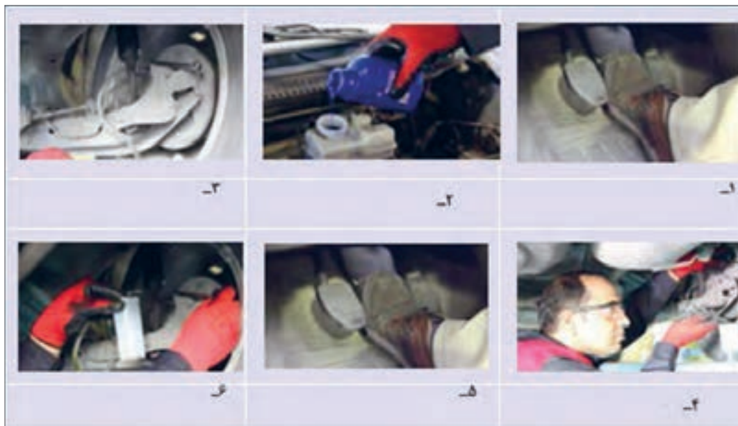
شکل ۱۹- مراحل هواگیری دستی مدار هیدرولیک ترمز
