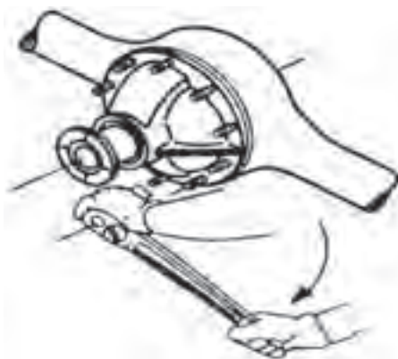
شکل ۶۴-۴ اعمال گشتاور مناسب هنگام بستن
