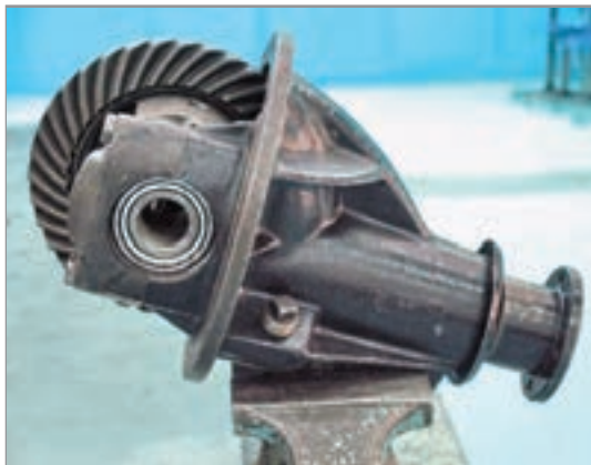
شکل ۴-۲۸- بستن مجموعه دیفرانسیل روی گیره
