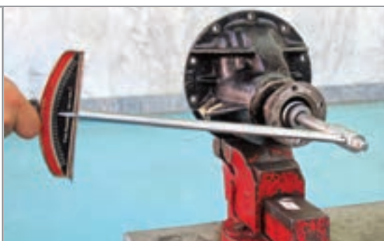
شکل ب ۵۶-۴- تعیین گشتاور پیش‌بار با گشتاورسنج
