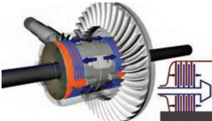
شکل ۶-۴- عملکرد دیفرانسیل ضد لغزش
