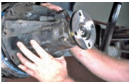
شکل ۲۵-۴- باز کردن مجموعه دیفرانسیل
