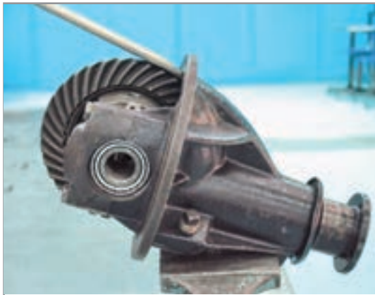
شکل ۳۰-۴ استفاده از اهرم
