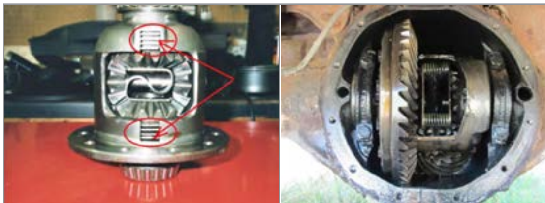
شکل ۷-۴- هوزینگ دیفرانسیل ضد لغزش و فنرها
