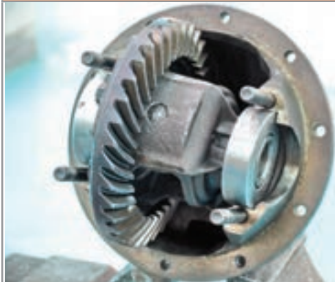
شکل ۴-۶۰- استفاده از رولبرینگ آزمایشی
