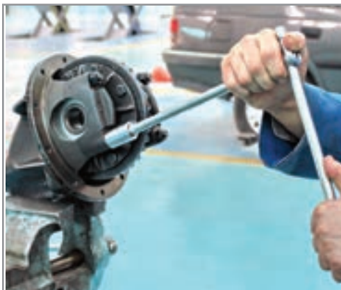
شکل ۶۱-۴- بستن کپه یاتاقان‌ها
