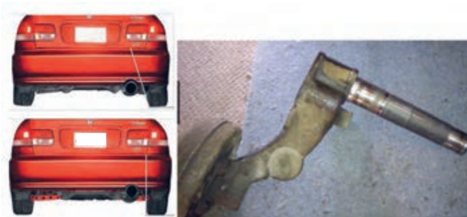
شکل ۴۵- خرابی بوش‌ها و تأثیر آن روی چرخ
