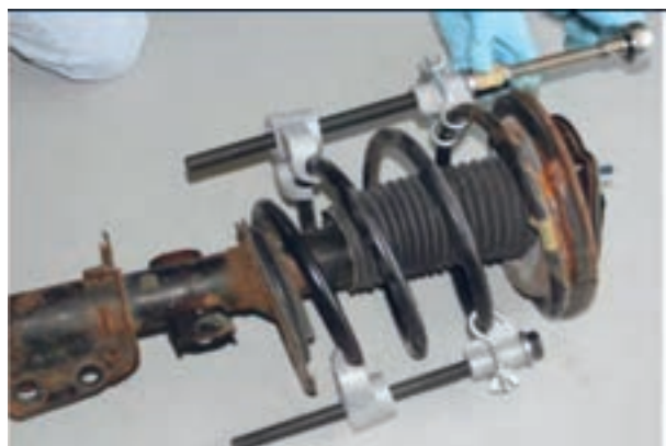
شکل ۳۶- برخی نکات باز کردن سیستم تعلیق مک فرسون
