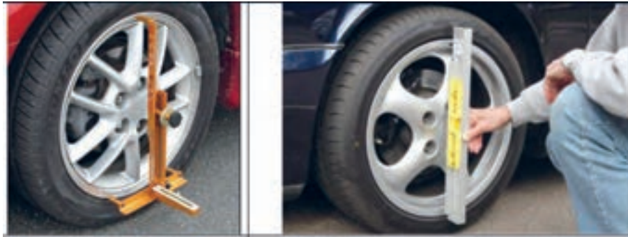
شکل ۴۲- ابزار مخصوص بررسی و تنظیم زوایای چرخ
