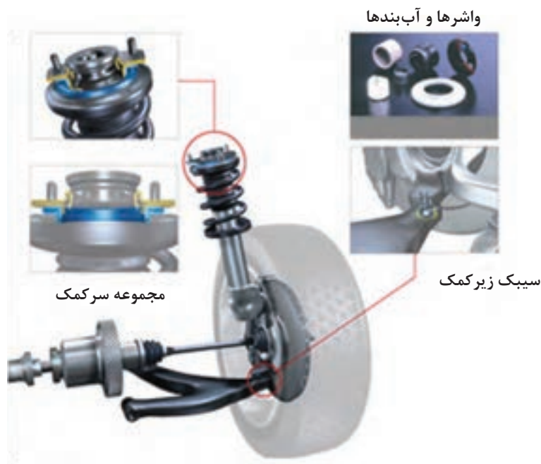
شکل ۳۴- برخی نقاط قابل تعمیر تعلیق مک فرسون
