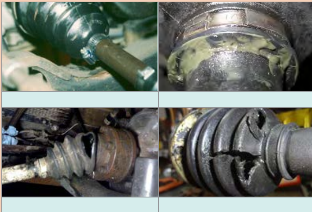
شکل ۱۷-۵- روش بررسی ظاهری پلوس‌ها
