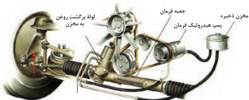
لوله رفت روغن از پمپ هیدرولیک به شیر هیدرولیک
