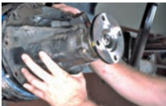
شکل ۲۵-۴ باز کردن مجموعه دیفرانسیل
