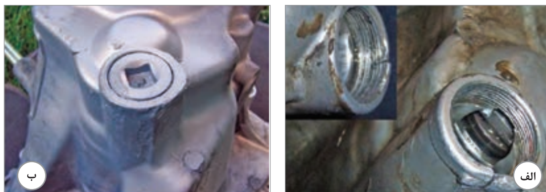
شکل ۳۲-۲ پوسته جعبه دنده و نحوه ترمیم آن
