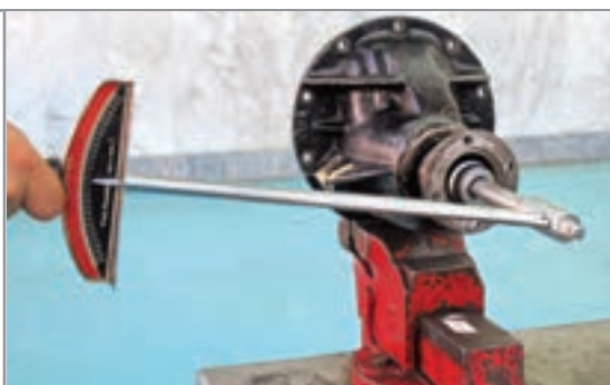
شکل ب ۵۶-۴- تعیین گشتاور پیش‌بار با گشتاورسنج
