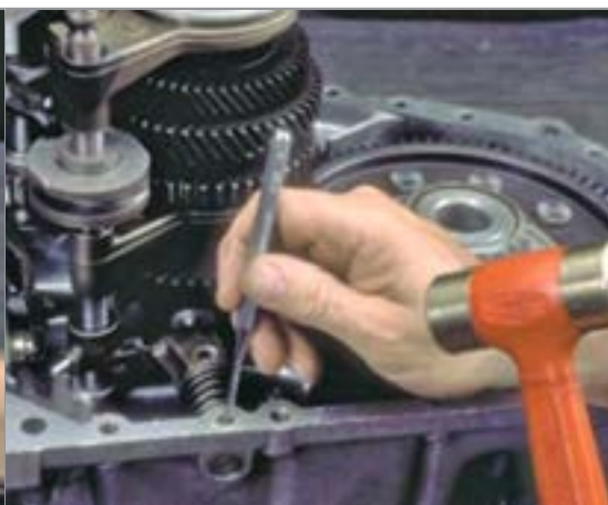
خارج کردن پین نگهدارنده اهرم تعویض دنده
