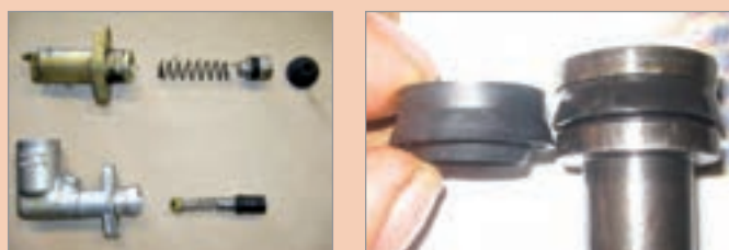
شکل ۲۱-۱ الف) نشتی داخلی در مدار هیدرولیکی
