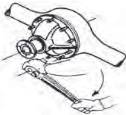
شکل ۴-۶۴- اعمال گشتاور مناسب هنگام بستن
