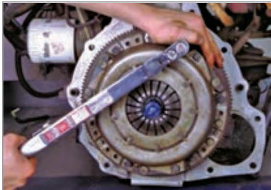
شکل ۱-۳۹- نحوه به گشتاور رساندن پیچ‌های دیسک کلاچ
