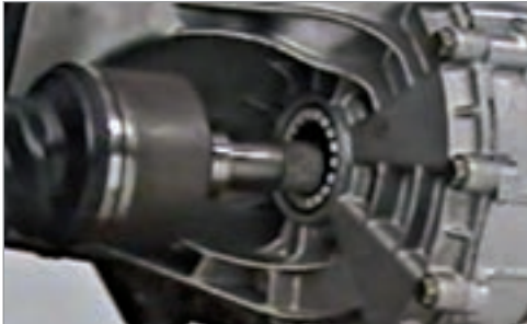
شکل ۱۹-۵- خارج کردن پلوس با ابزار مخصوص
