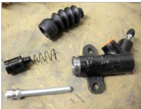
شکل ۱-۲۴- اجزای سیلندر اصلی کلاچ
