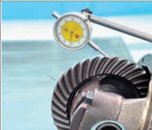
شکل ۶۲-۴- اندازه‌گیری لقی بین دنده‌ها
