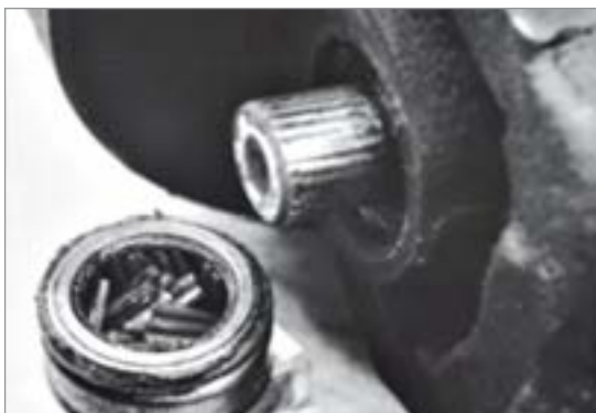
شکل ۳-۲۳- بررسی ساچمه سوزنی
