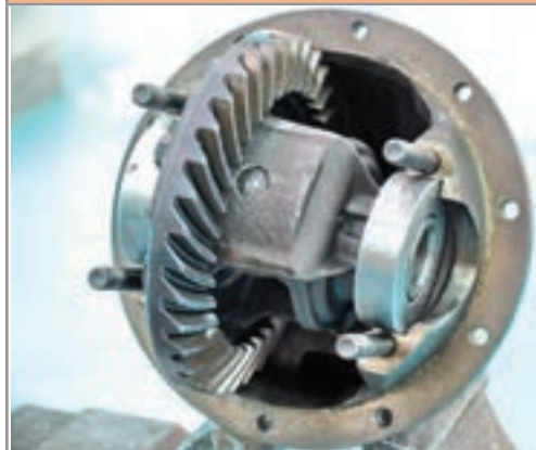
شکل ۴-۶۰- استفاده از رولبرینگ آزمایشی
