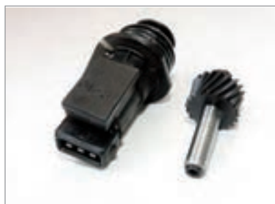
شکل ۲۰-۲ حسگر سرعت خودرو روی جعبه‌دنده
