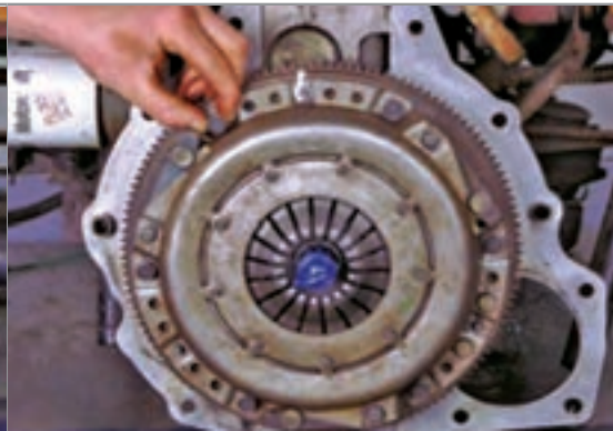
شکل ۱-۳۸- نحوه بستن پیچ‌های دیسک با دست
