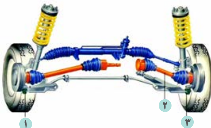
شکل ۵-۵- پلوس ها در خودروی جلو محرک
