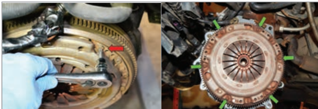
مشخص کردن محل پیچ‌های اتصال
