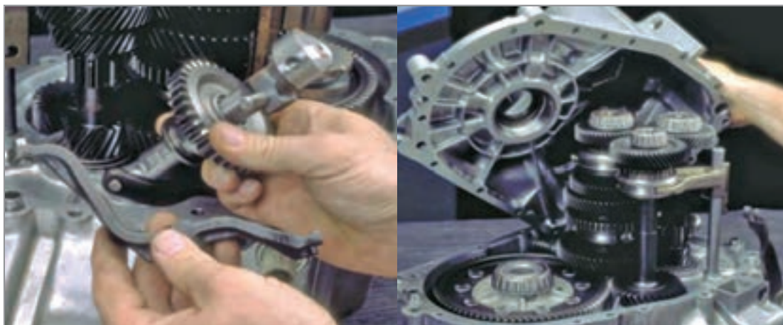
باز کردن پوسته جعبه‌دنده
