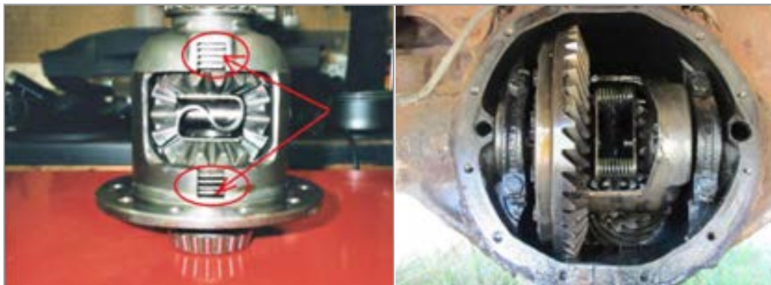
شکل ۷-۴- هوزینگ دیفرانسیل ضد لغزش و فنرها
