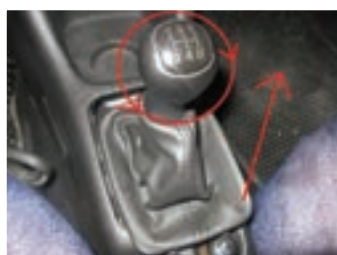
شکل ۲-۲۳- تعویض گردگیر دسته دنده
