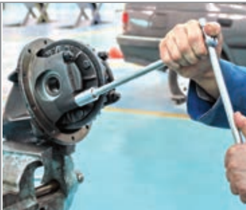
شکل ۶۱-۴- بستن کپه یاتاقان‌ها
