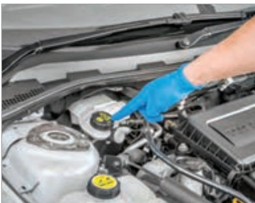
شکل ۱۶-۱- مخزن مایع مشترک در یک خودرو
