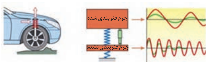
شکل ۲۶- عملکرد سیستم فنربندی تعلیق
