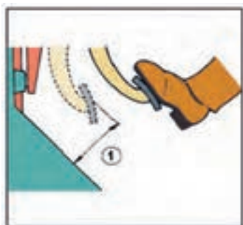
شکل ۱۶- بازدید فاصله پدال ترمز تا کف
