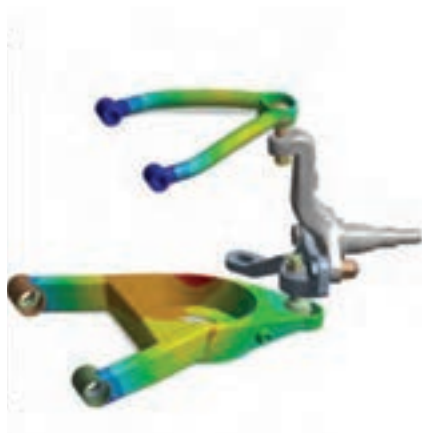
شکل ۱۵- سگدست و محور آن
