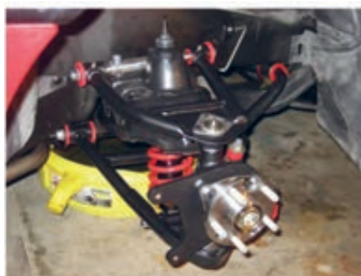
شکل ۳۹- مجموعه تعلیق طبق دار دویل و روش تنظیم زوایا
