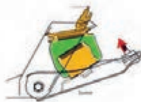
شکل ۲۴- فنر بادی و نحوه‌ی عملکرد آن
