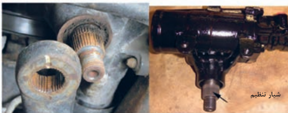
شکل ۳۲ - هزار خار محور خروجی جعبه فرمان
