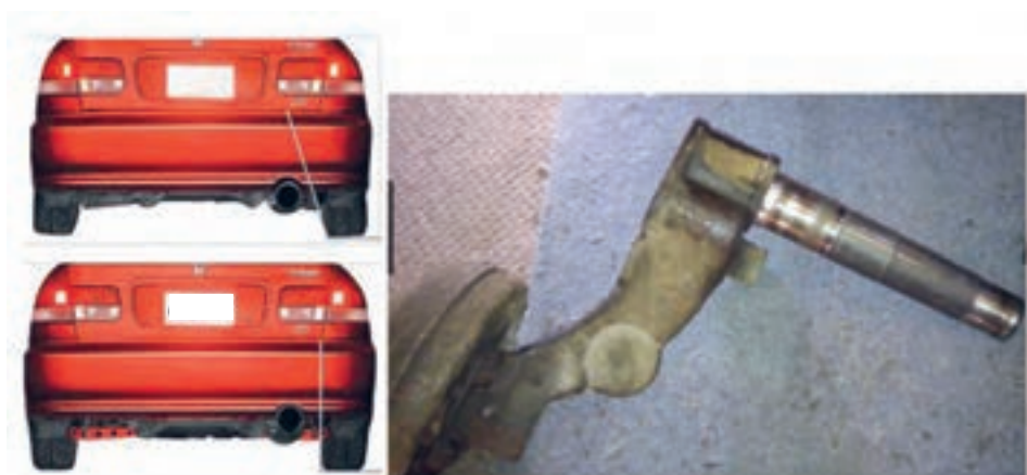
شکل ۴۵- خرابی بوش‌ها و تأثیر آن روی چرخ
