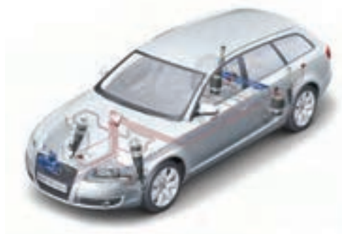
شکل ۳۰- سیستم تعلیق فعال
