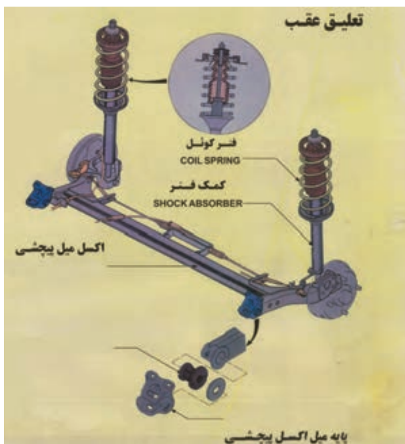
شکل ۴۸- تعلیق با اکسل میل پیچشی
