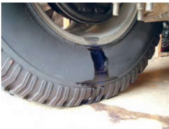
شکل ۴۱- وجود مایع اطراف چرخ عقب
