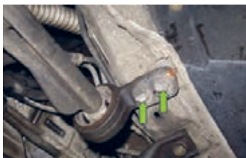
گشتاور سنجی اتصالات پیچ و مهره ای
