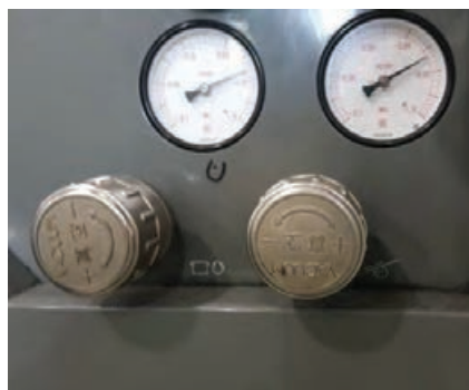
شکل ۴۲- شیر تنظیم مکش (شیر سمت چپ)
