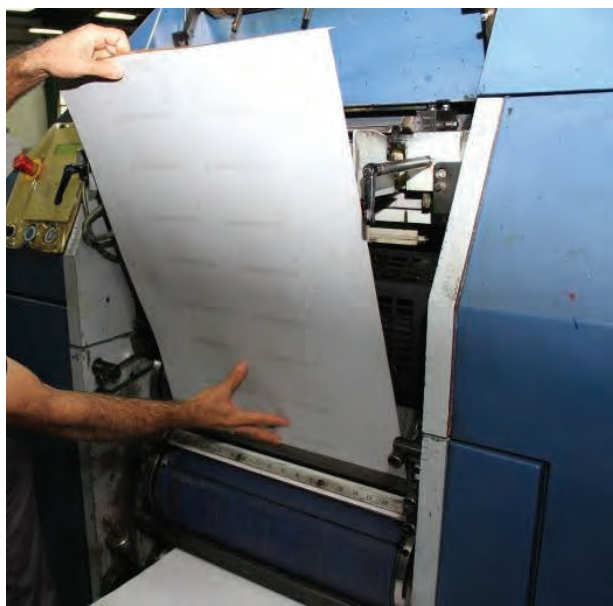
شکل ۶۹- قرار دادن لب کار در شیار سیلندر
