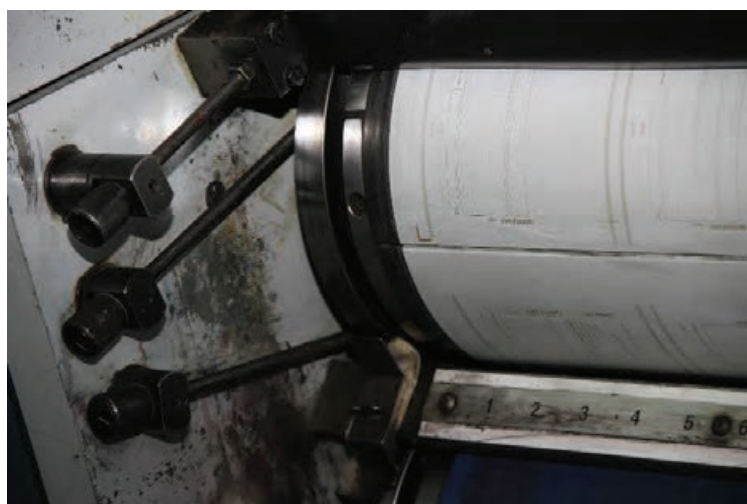
شکل ۵۳- شیار سیلندر (لبه‌های پلیت)
