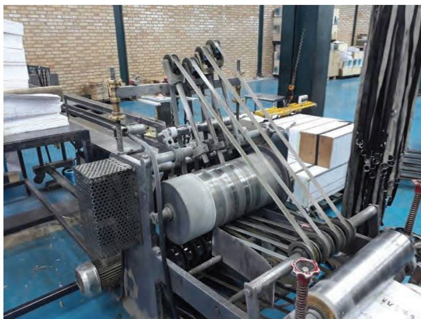
شکل ۴۸- سیلندر پرس و دسته کن (Stacker)
