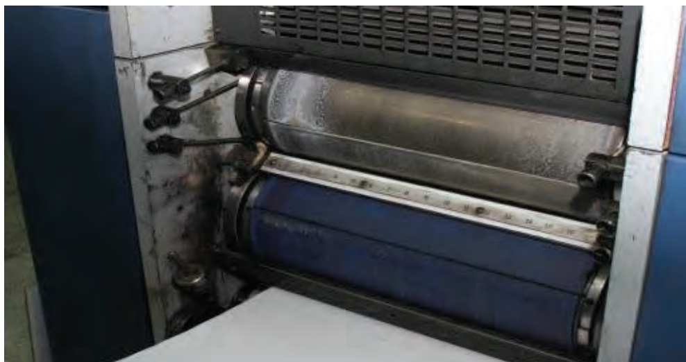
شکل ۶۸- سیلندر آماده بستن پلیت
