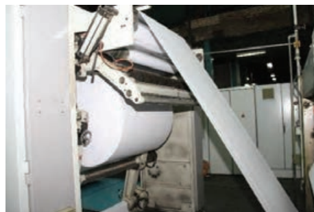
شکل ۹- سیستم عملکرد تغذیه بدون توقف (Splicer)
