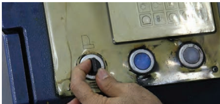
شکل ۵۲- کلید آزاد کردن سیلندرها
