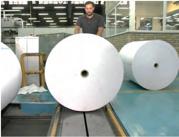
شکل ۱۵- انتقال رول از ریل به روی واگن
