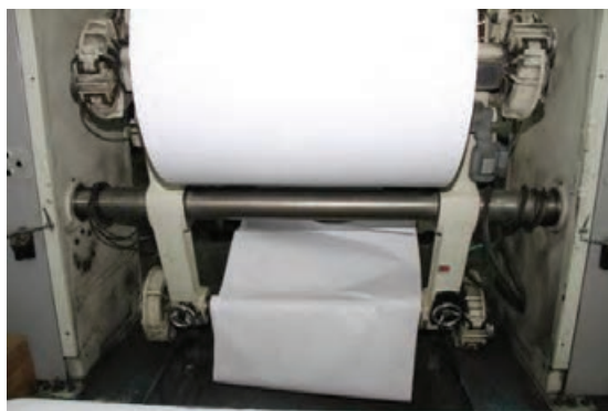
شکل ۱۱- ته رول خارج شده از تغذیه
