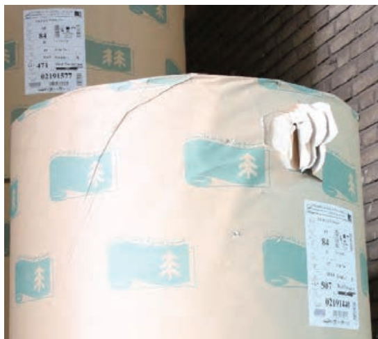
شکل ۶- خراش و پارگی روی بدنه رول
