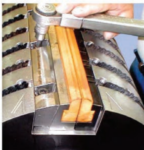
شکل ۳۶- باز و بست با یک تیغه برش
