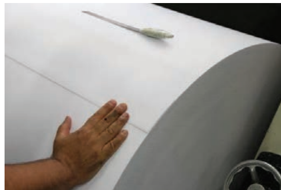
شکل ۱۶- تا کردن لبه رول
