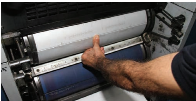
شکل ۷۱- قرارگیری ته کار پلیت در شیار سیلندر
