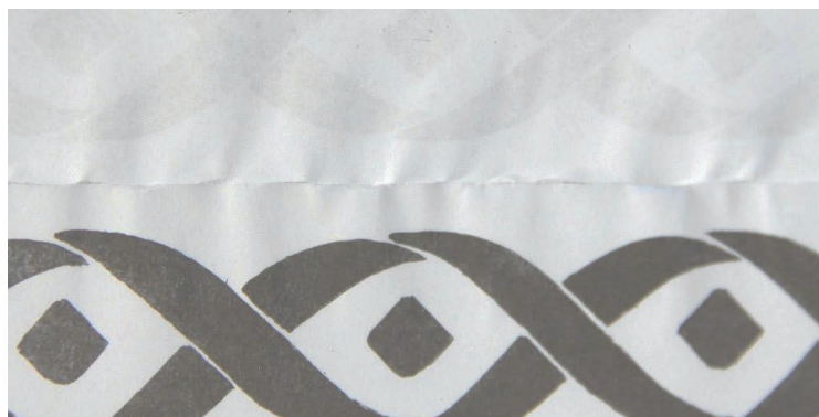
شکل ۳- ورود چسب بیش از اندازه به بافت کاغذ
