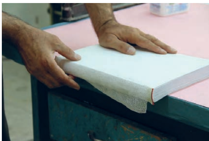
شکل ۱۰- تنظیف و شیرازه‌گذاری بلوک
