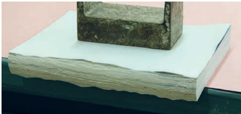
شکل ۴- غیر یکنواخت شدن چسب در عطف کتاب
