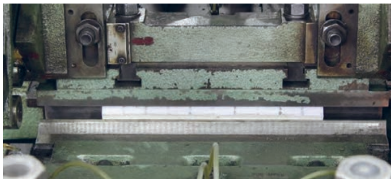
شکل ۵۹- عمل ته‌کوبی عطف بلوک توسط قالب
