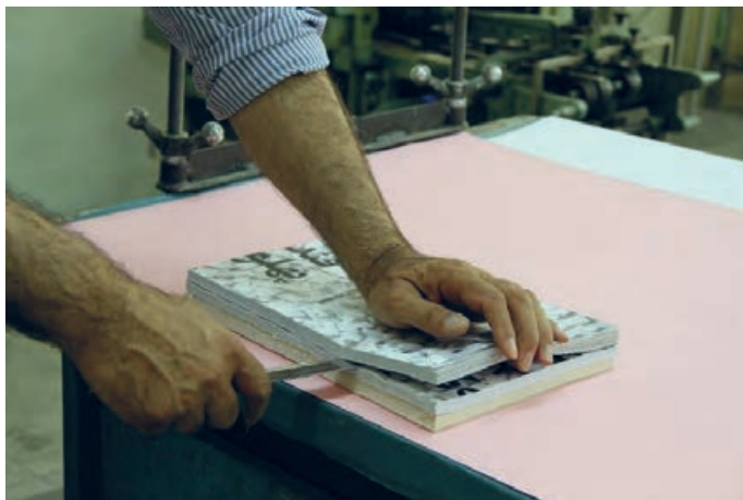
شکل ۱۴- جدا کردن بلوک‌ها از یکدیگر
