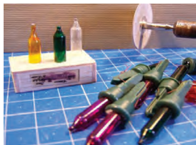
ساخت لیوان با سری خودکار و ساخت بطری با سری قطره چکان
