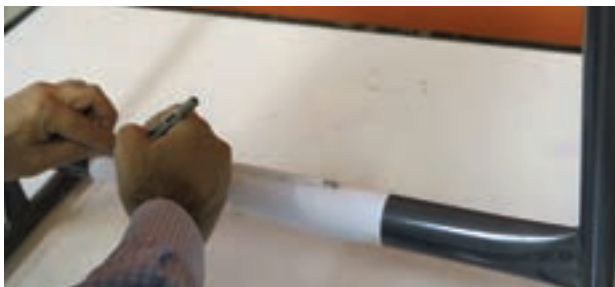
◀ تصویر ۲۱-۱ علامت گذاری فاصله های ده سانتی متری از دو طرف نقطه میانی زیر دار
