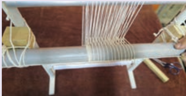
مراحل تکمیل کوچی بندی و خارج ساختن چوب صیقلی تصویر ۳۵-۱ ▲
