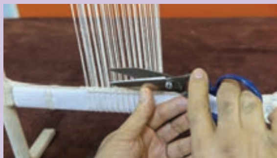
روش صحیح در دست گرفتن قیچی و حرکت آن
