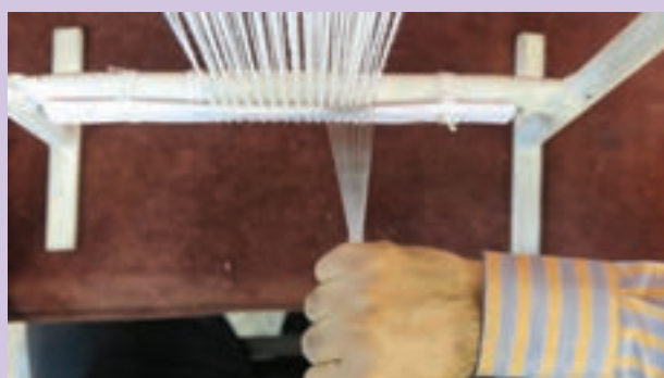
حالت و روش صحیح دفتین زدن
