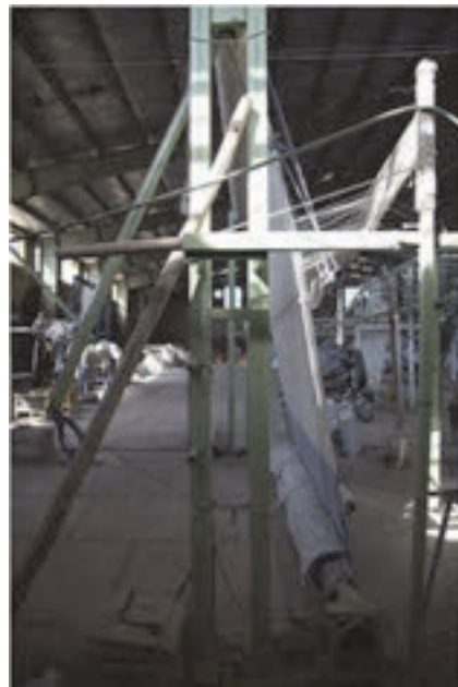
شکل ۴۸- دستگاه متحرک با اتصالات پیچ و مهره
