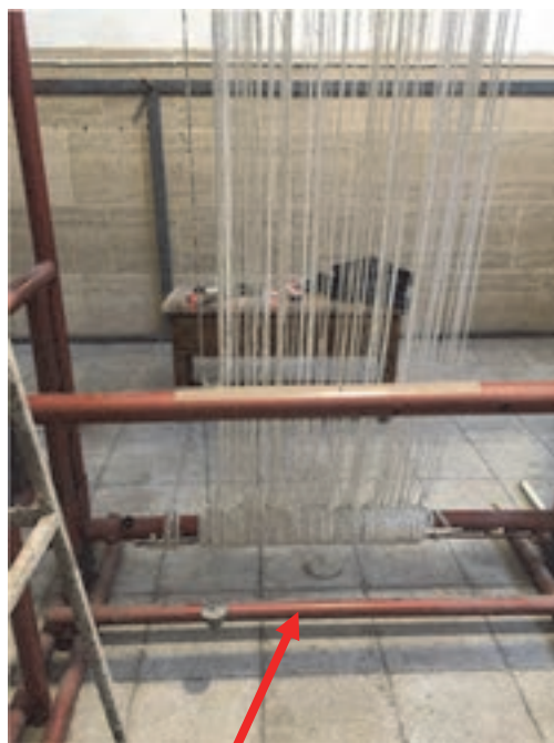
شکل ۴۴- تنظیم چله‌ها به کمک شاغول
