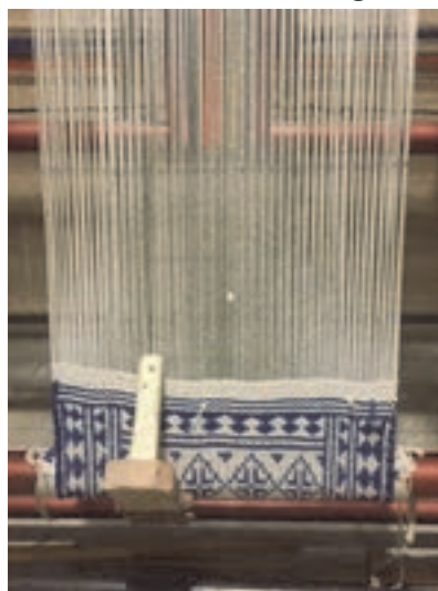
شکل ۷۹- جمع کردن زیلو بر روی تیر پایین
