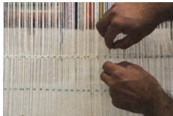
شکل ۷۲- مرتب کردن و تنظیم فاصله چله‌ها
