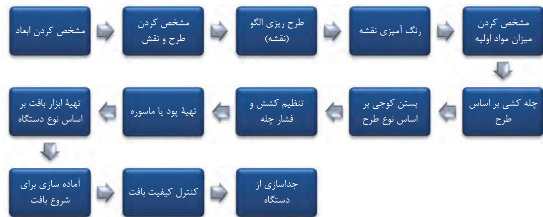
نمودار ۲-۳ مراحل شکل‌گیری جاجیم
