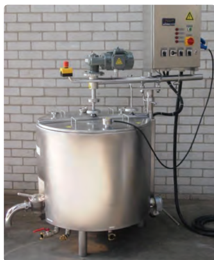
شکل ۱-۱۷- سیستم پاستوریزاسیون غیرمداوم
