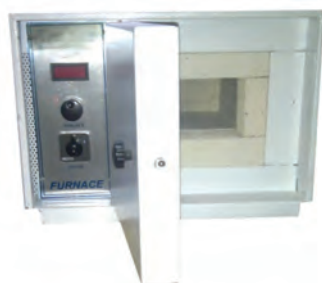
شکل ۲-۱۶- وسایل مورد استفاده برای آزمایش اندازه‌گیری خاکستر
