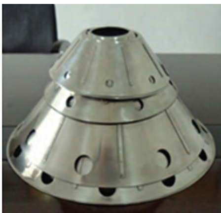
شکل ۵-۶- سپراتور و صفحات داخلی آن
