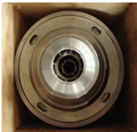
شکل ۵-۶- سپراتور و صفحات داخلی آن
