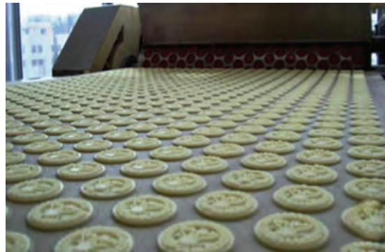
شکل ۷- قالب‌زنی بیسکویت با ماشین قالب‌زن دوار
