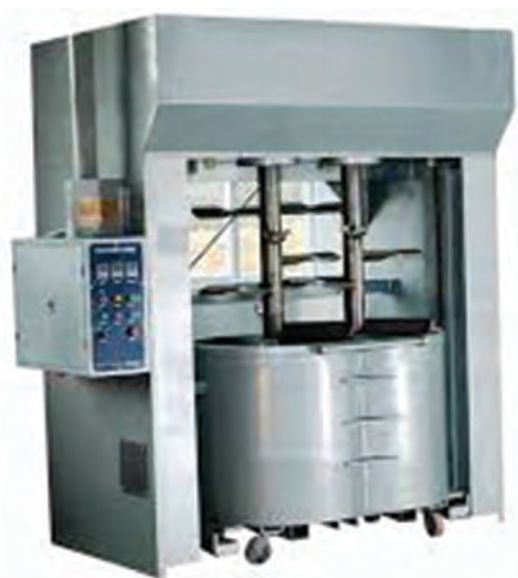
شکل ۲- مخلوط‌کن عمودی با مخزن قابل جدا شدن
