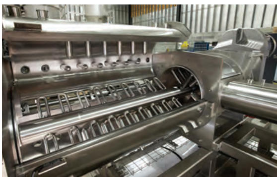
شکل ۴- مخلوط‌کردن بیسکویت به روش مداوم
