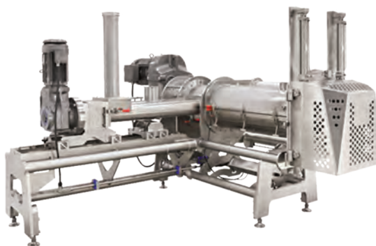
شکل ۴- مخلوط‌کردن بیسکویت به روش مداوم
