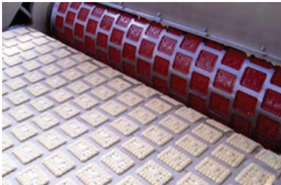
شکل ۷- قالب‌زنی بیسکویت با ماشین قالب‌زن دوار
