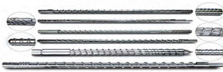
شکل ۱۱- انواع ماریپیچ برای ورز دادن خمیر در اکسترودر
