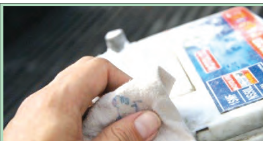
شکل ۱۹- پاک کردن قطب‌ها با دستمال نرم و خشک
