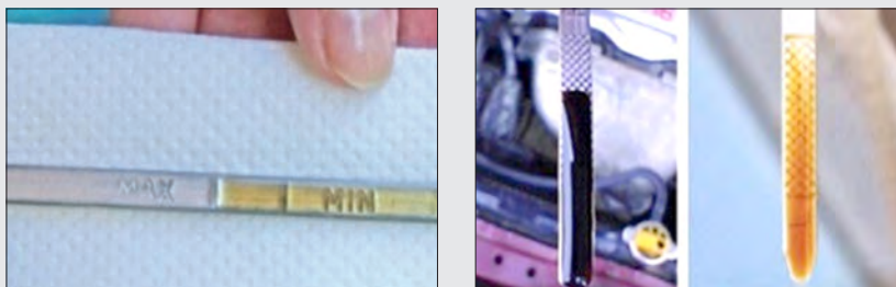
شکل ۱۰-۱- سنجش روغن
