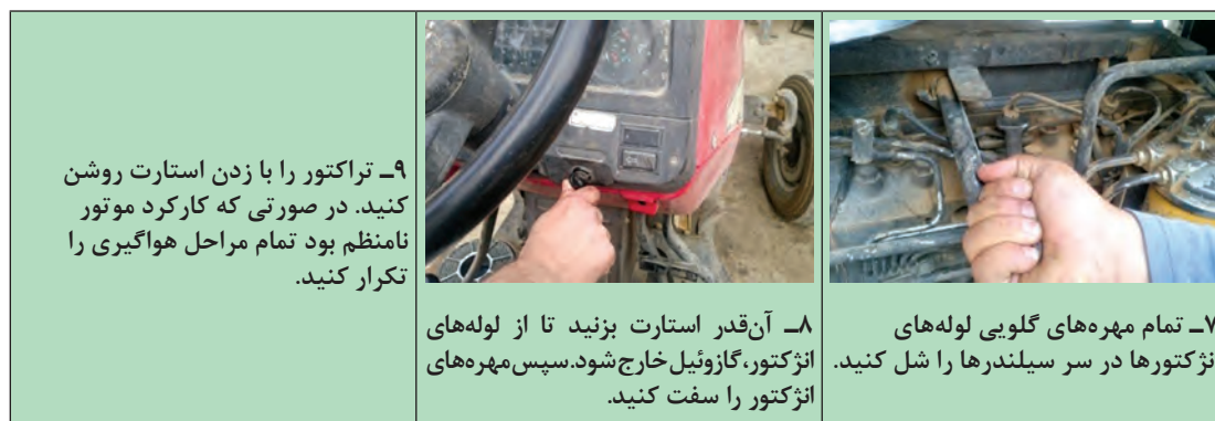
شکل ۴۰-۱- مراحل هواگیری سیستم سوخت رسانی
