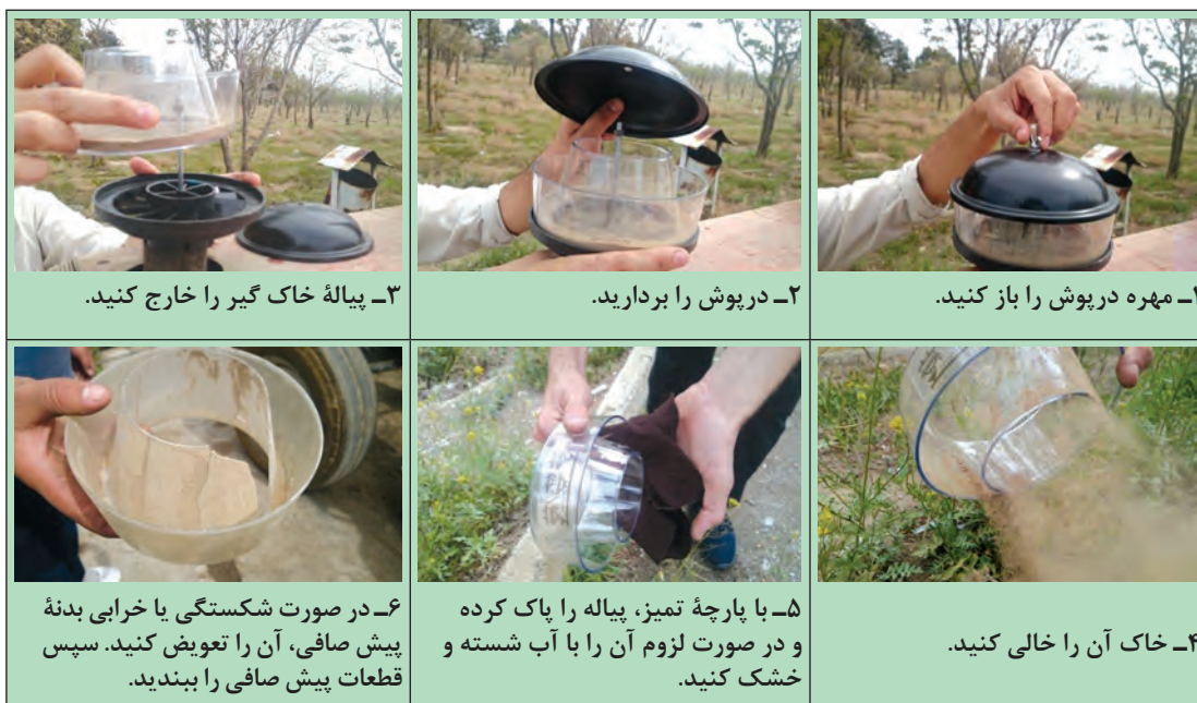
شکل ۳۱-۱- مراحل تمیز کردن پیش صافی
