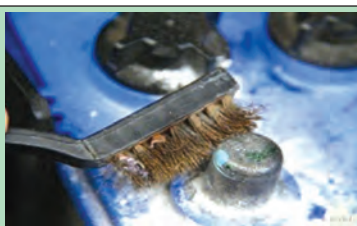
شکل ۱۷- تمیز کردن قطب‌ها با برس سیمی
