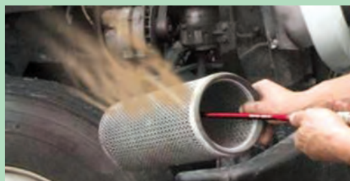
شکل ۳۵-۱- تمیز کردن صافی خشک با فشار هوا
