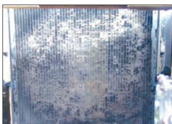
شکل ۱-۴۴- رادیاتور با شبکه کثیف
