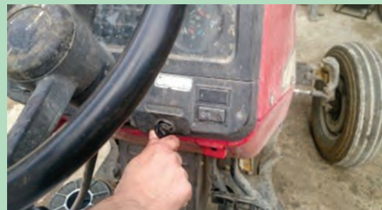
شکل ۴۷-۱- مراحل تعویض ضد یخ
