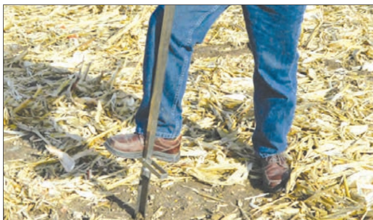
شکل ۹-۲- برداشت نمونه خاک با اُگر
