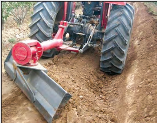
شکل ۲۷-۲- زاویه تیغه و ریزش خاک در چاله
