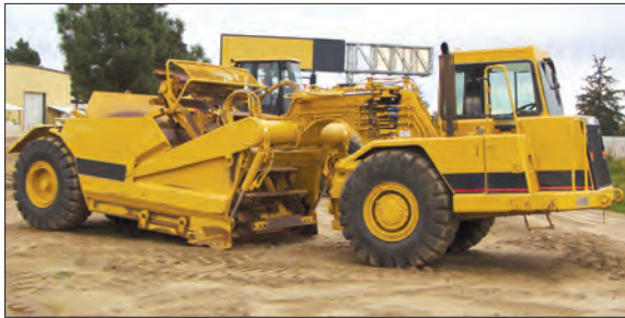
شکل ۲۰-۲- ماشین‌های سنگ جمع‌کن و اسکرپور
