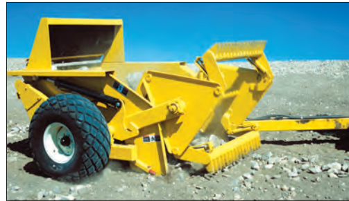
شکل ۲۰-۲- ماشین‌های سنگ جمع‌کن و اسکرپور
