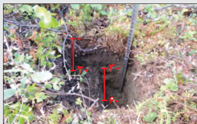
شکل ۱۵-۲ روش نمونه‌برداری از دو عمق ۳۰-۶۰ و ۳۰-۶۰
