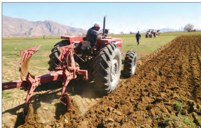
شکل ۳۶-۳- اجرای شخم با گاوآهن برگردان‌دار دو طرفه
