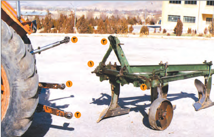
شکل ۲۸-۳- اتصال گاواهن به تراکتور
