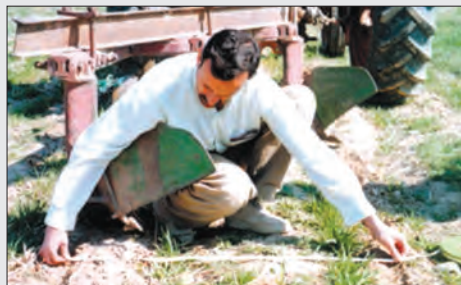
شکل ۳۷-۳- اندازه‌گیری عرض کار گاواهن برگردان دار
