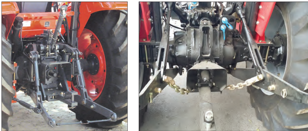
شکل ۳۲-۳- زنجیر تنظیم تعادل یا نوسان گیر
