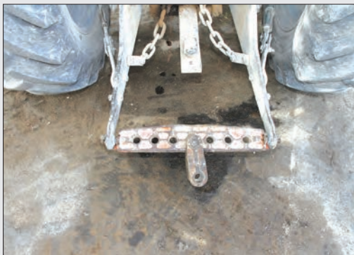
شکل ۲۹-۴- مالبند بلند و اتصال سه نقطه
