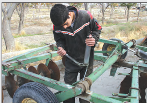
شکل ۲۱-۴- گریس کاری دیسک
