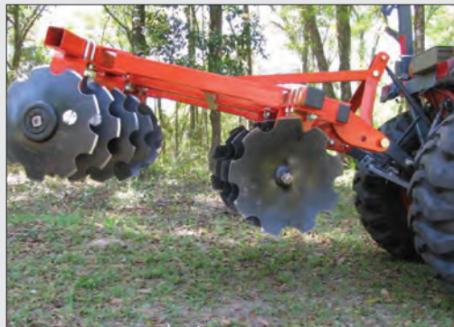
شکل ۲۹-۴- مالبند بلند و اتصال سه نقطه
