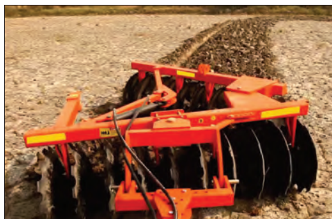
شکل ۲۸-۴ تغییر زاویه استقرار ردیف بشقاب‌ها روی شاسی
