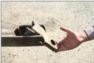
شکل ۱۸-۴- شکستگی نقطه اتصال و بشقاب
