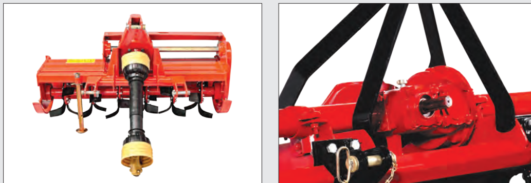
شکل ۲۵-۴- گاردان و محور توان‌دهی
