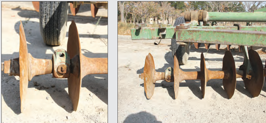
شکل ۱۹-۴- یاتاقان خراب بشقاب
