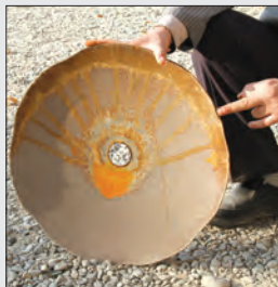
شکل ۱۸-۴- شکستگی نقطه اتصال و بشقاب
