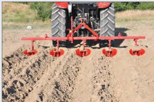
شکل ۳۲-۵- شیارکش در حال ایجاد شیار
