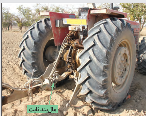
شکل ۱۶-۵- نقطهٔ اتصال در صاف‌کننده کششی
