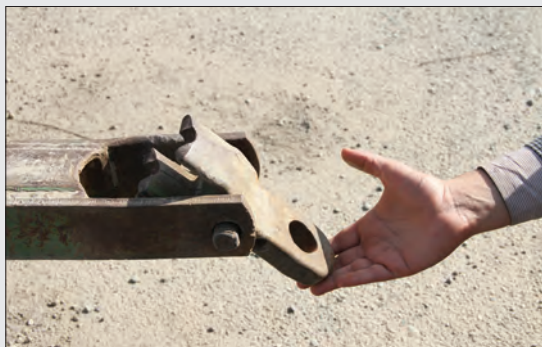
شکل ۱۲-۵- شکستگی نقطه اتصال صاف کننده
