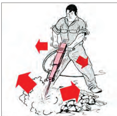
شکل ۳-۲- عوارض ناشی از ارتعاش
