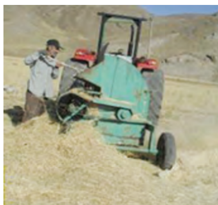
خرمین کوب پشت تراکتور در حال کار
