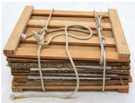
شکل ۱۷- تخته پرس مخصوص خشک کردن نمونه‌های گیاهی
