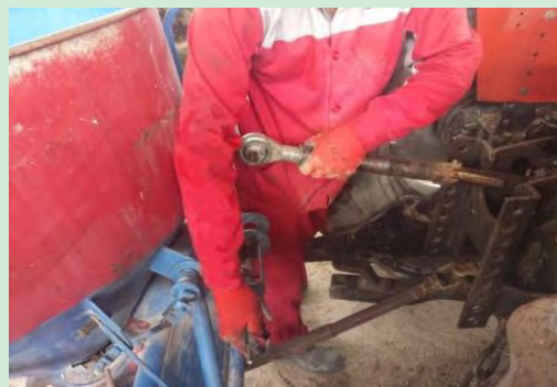
شکل ۱۰- اتصال بازوی وسط تراکتور به بذرپاش
