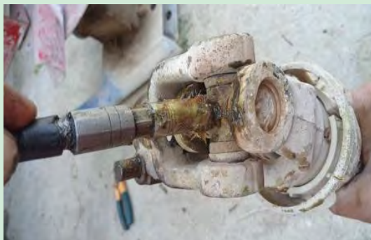
شکل ۱۵- گریس کاری گاردان و بذریاش
