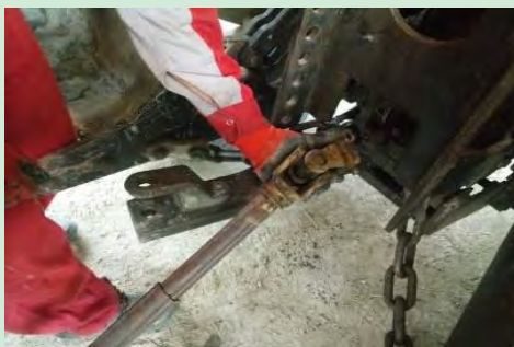
شکل ۹- نصب گاردان بین بذرپاش و تراکتور
