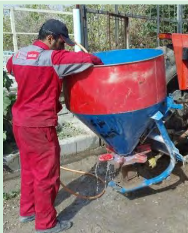
شکل ۱۲- تمیز کردن بذرپاش
