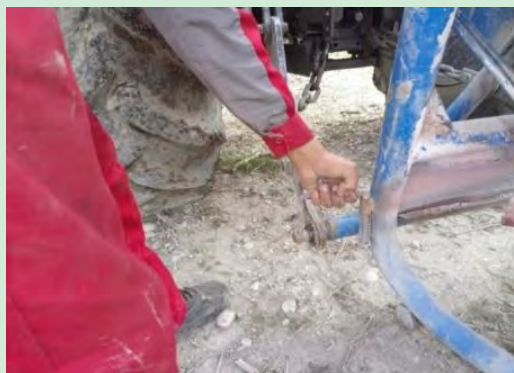
شکل ۸- اتصال بذرپاش به بازوهای کناری تراکتور
