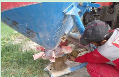
شکل ۹- نصب گاردان بین بذرپاش و تراکتور
