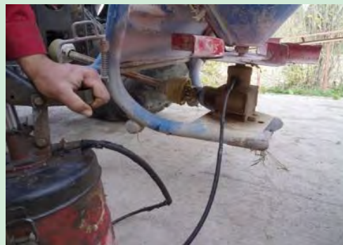
شکل ۱۵- گریس کاری گاردان و بذریاش
