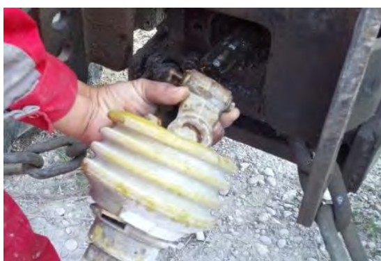
شکل ۱۱- اتصال گاردان به تراکتور
