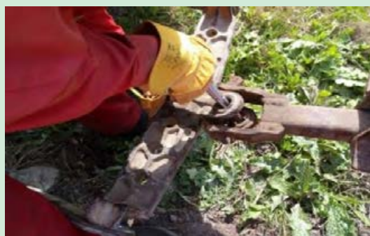
شکل ۱۱- اتصال دیسک کششی هیدرولیکی
