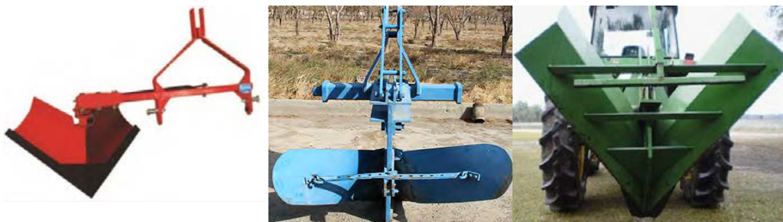
شکل ۲۰- انواع نه‌رکن سوار: ثابت - قابل تنظیم - کناری
