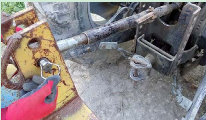
شکل ۲۳- اتصال بازوی وسط تراکتور به نه‌رکن
