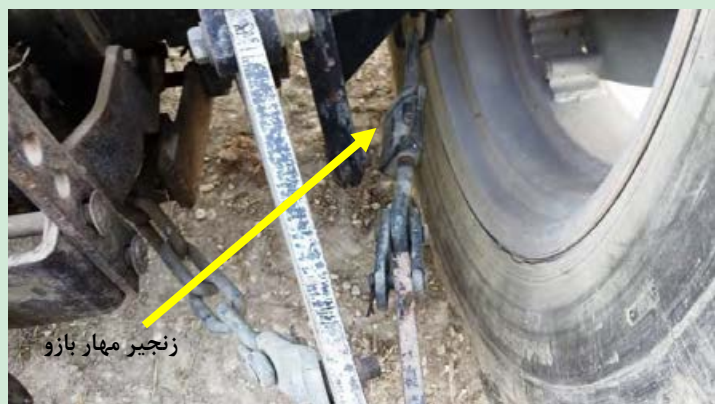
شکل ۲۴- زنجیر مه‌ار. برای تنظیم تعادلی
