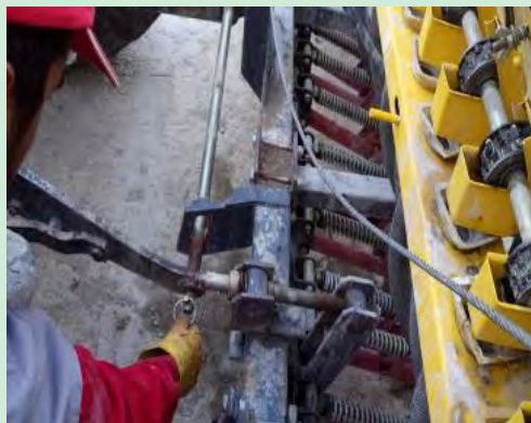
شکل ۱۳- متصل کردن خطی کار به تراکتور
