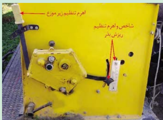
شکل ۱۷- اهرم تنظیم ریزش بذر
