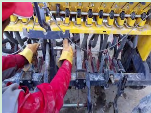
شکل ۱۳- متصل کردن خطی کار به تراکتور
