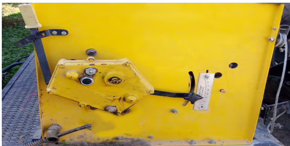
شکل ۱۵- جعبه دنده و درجه ریزش بذر
