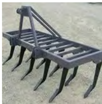
شکل ۱۹- گاواهن قلمی (اسکنه‌ای یا چیزل) به صورت غیر ترکیبی (مجزا)
