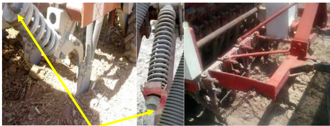
شکل ۵۲- شیار بازکن مستقر شدن با پیچ روی تیر افزار شکل ۵۳- شیار بازکن و مهره نگهدارنده فنر و تنظیم فشار
