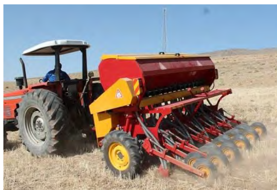
شکل ۳۵- کودکار بذرکار کشت مستقیم دیم مدل شاهین
