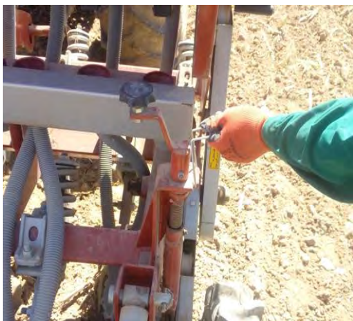
شکل ۵۱- آزاد کردن ضامن و تنظیم عمق کاشت با چرخش اهرم
