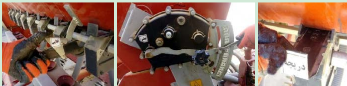
شکل ۵۹- قرار دادن اهرم‌های تنظیم در موقعیت‌هایی که در واسنجی تعیین شده‌اند
