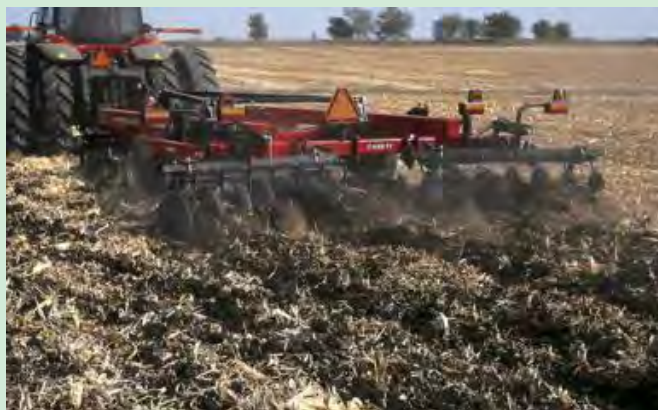
شکل ۳۲- نمونه ماشین مرکب خاک‌ورزی
