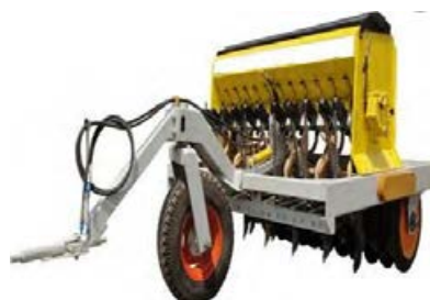
شکل ۴۹- ماشین دیم کار کششی با تک تقطه اتصال و شیلنگ های هیدرولیک
