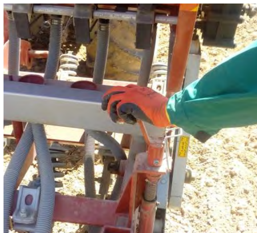
شکل ۵۱- آزاد کردن ضامن و تنظیم عمق کاشت با چرخش اهرم
