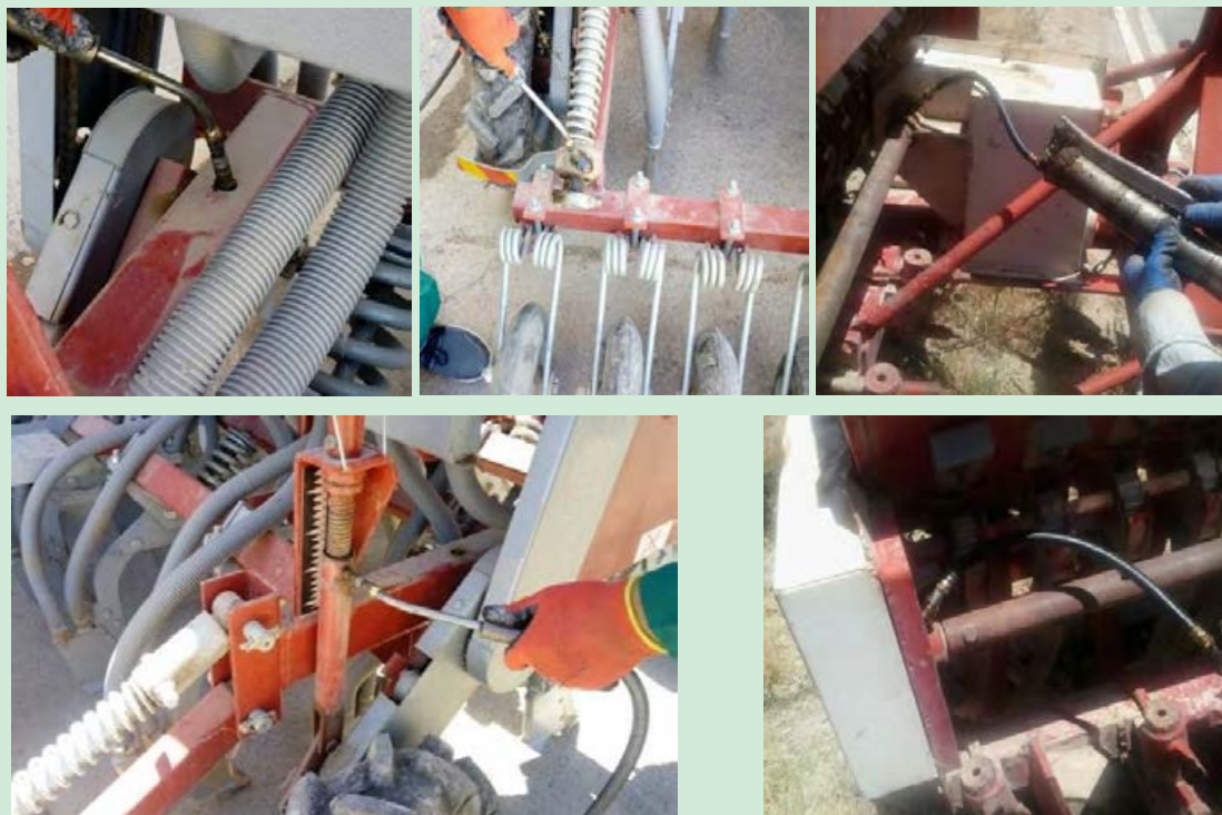
شکل ۴۲- برخی از گریس خورهای کارنده‌های دیم. گریس خورها برحسب دستگاه تفاوت دارند. اغلب کلاج گیربکس دارند، چرخ جلو، یاتاقان‌های چدنی، و سامانه تنظیم کارنده‌ها دارای گریس خور هستند.
