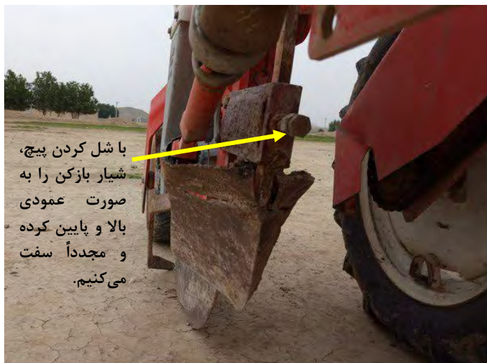
شکل ۲۰- تنظیم شیار بازکن
