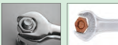
شکل ۹-۱- اندازه مناسب آچار (الف) (ب)
