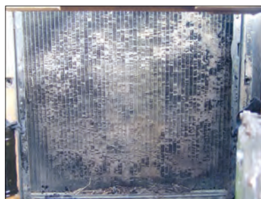
شکل ۴۰-۲- کثیف شدن سطح خارجی رادیاتور
