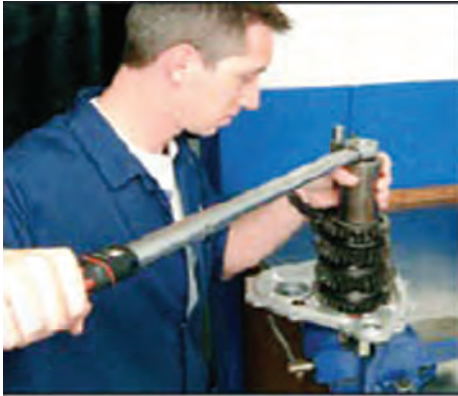
شکل ۱۲-۱ کار با ترک متر قابل تنظیم
