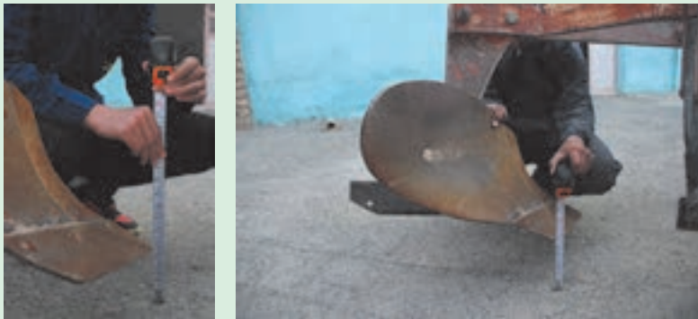
شکل ۳۰-۱. اندازه‌گیری فاصله تیغه جهت تراز عرضی
