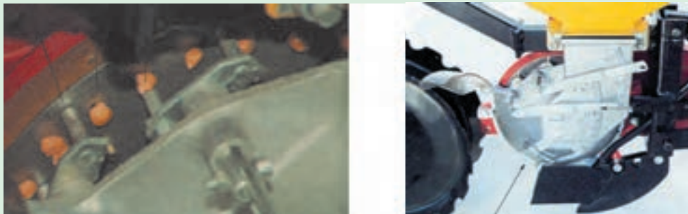
شکل ۳۶-۳. تنظیم تک‌دانه‌کن در ردیف‌کار نیوماتیکی
