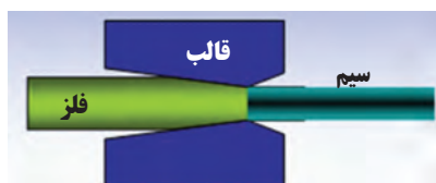
شکل ۲۵-۵- تولید سیم به روش کشش
