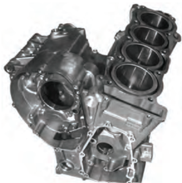
شکل ۲۰-۵- بدنه موتور (چدن خاکستری)
