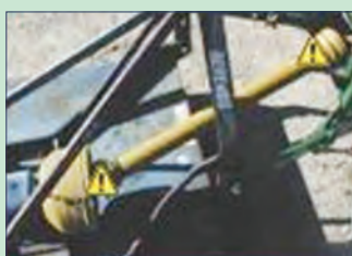
شکل ۷۶-۳- حداکثر زاویه گاردان ۲۵ درجه است.
