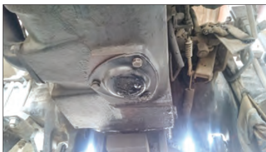
شکل ۳۲-۳ درپوش تخلیه روغن هیدرولیک تراکتور MF ۲۸۵
