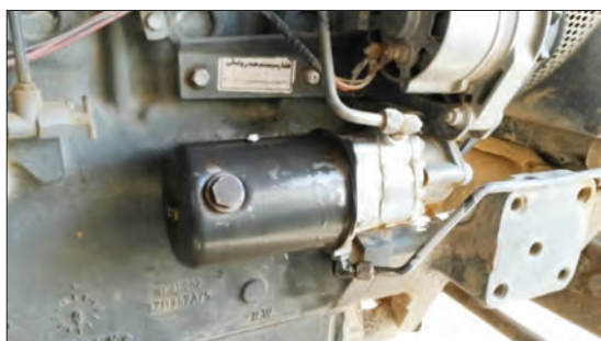
شکل ۴۰-۳- محل بازدید روغن پمپ فرمان تراکتور فرگوسن ۲۸۵
