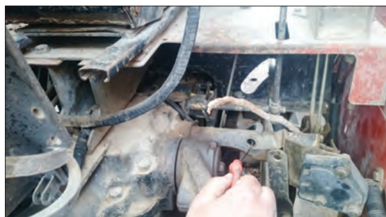
شکل ۲۹-۳- گیج روغن هیدرولیک تراکتور فرگوسن ۳۹۹
