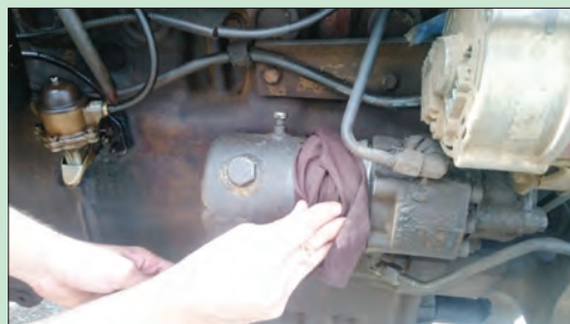
شکل ۴۱-۳- تمیز کردن پوسته روغن فرمان
