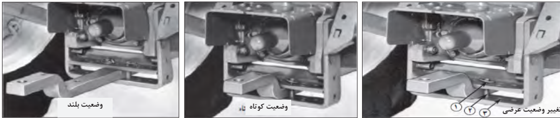
شکل ۵۷-۳- تنظیمات مالبند قابل تنظیم
