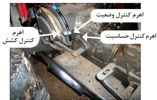
شکل ۳-۵۹- اهرم‌های کنترل هیدرولیک تراکتور فرگوسن ۲۸۵
