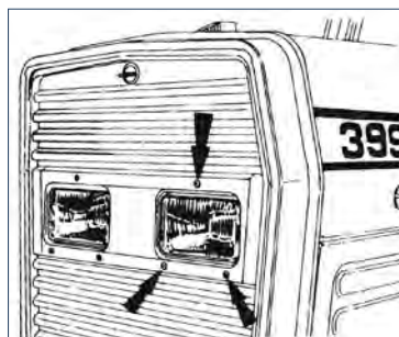
شکل ۱۸-۳- پیچ های تنظیم چراغ
