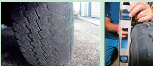
شکل ۴۳-۳- تأثیر تنظیم نبودن زوایای چرخ جلو
