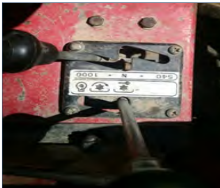
شکل ۷۱-۳- اهرم‌های کنترل محور تواندهی فرگوسن ۳۹۹
