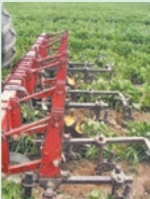
شکل ۱۳-۴. پنجه شاخه ای در حال کار
