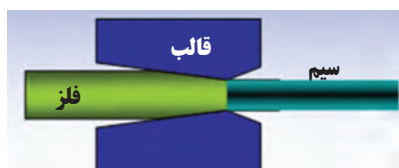
شکل ۵-۲۵- تولید سیم به روش کشش
