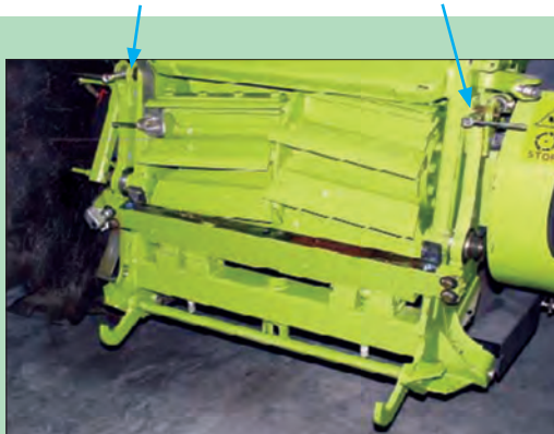
شکل ۲۸- اهرم‌های تنظیم تیغه ثابت در چاپر خودگردان
