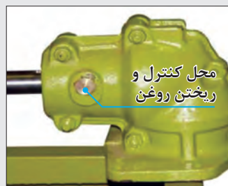
شکل ۴۶- جعبه دنده زانویی تیغه درو
