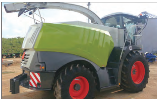
شکل ۳۶- نشیمنگاه لوله تخلیه
