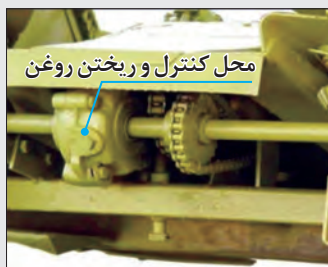
شکل ۴۷- جعبه دنده دوکفه‌ای
