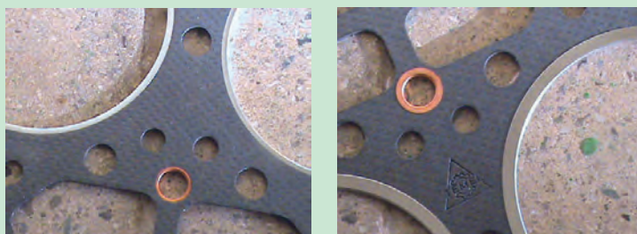
شکل ۸۷. تفاوت ضخامت قسمت‌های مسی روی واشر سرسیلندر
