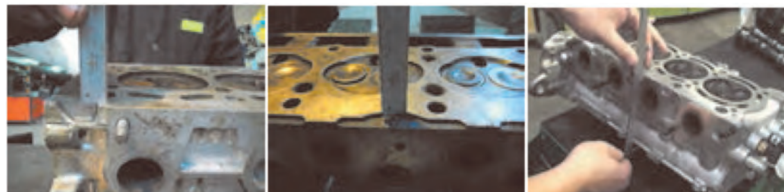
شکل ۸۳. کنترل ارتفاع مجاز کف تراشی سر سیلندر
