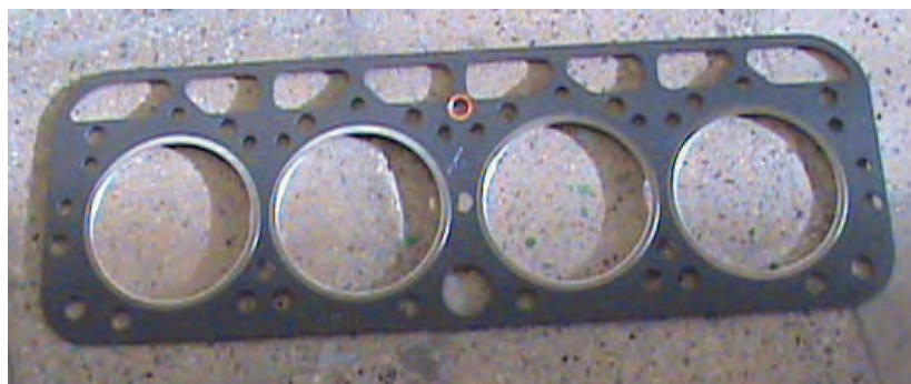
شکل ۱۳- واشر سر سیلندر تراکتور رومانی (U650)
