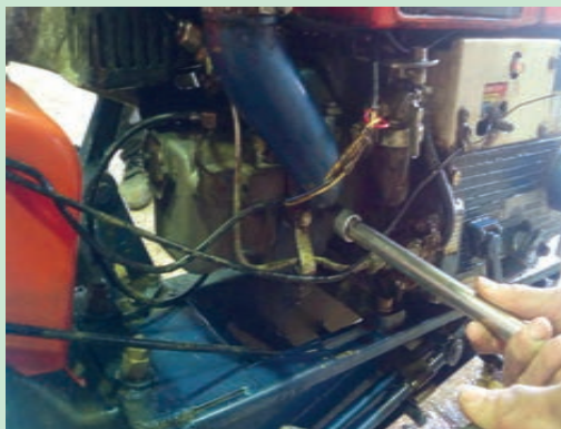
شکل ۵۲. باز کردن مانیفولد هوا
