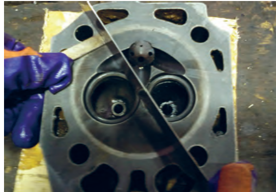
شکل ۶۵. کنترل تابیدگی سرسیلندر تراکتور دوچرخ
