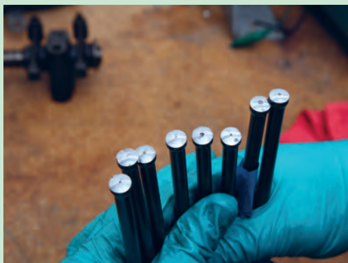
شکل ۴۷. خارج کردن میل تپت‌ها
