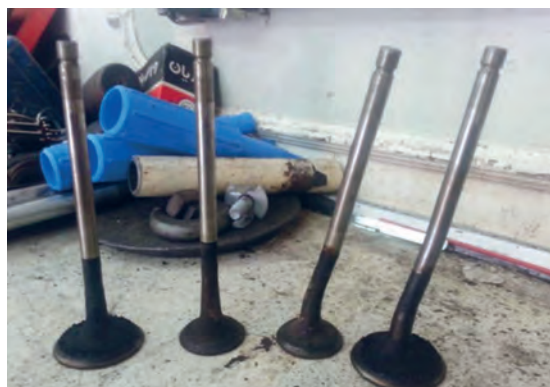
شکل ۶۷. کربن گرفتگی سرسیلندر و سوپاپ‌ها
