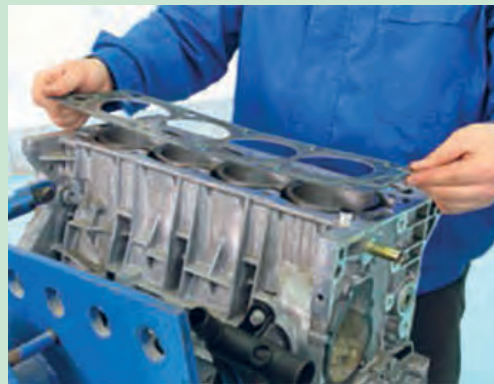
شکل ۵۰. برداشتن و اثر سر سیلندر
