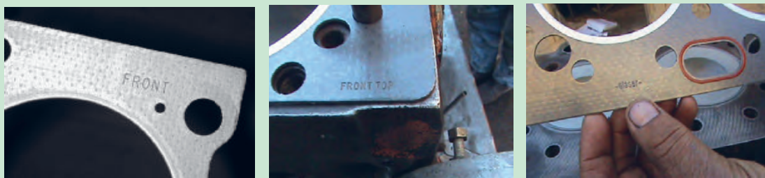
شکل ۸۶. علامت‌های روی واشر سرسیلندر
