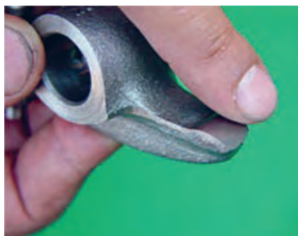
شکل ۷۵. فرسودگی سر اسبک
