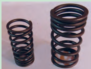
شکل ۱۸. فنرهای سوپاپ در تراکتور MF۲۸۵
