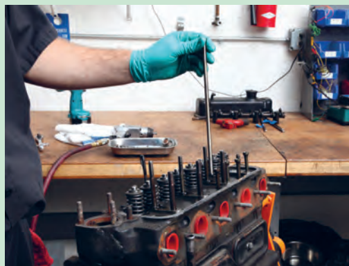
شکل ۴۷. خارج کردن میل تپت‌ها
