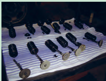
شکل ۵۹. چیدن اجزای سوپاپ به ترتیب باز شدن
