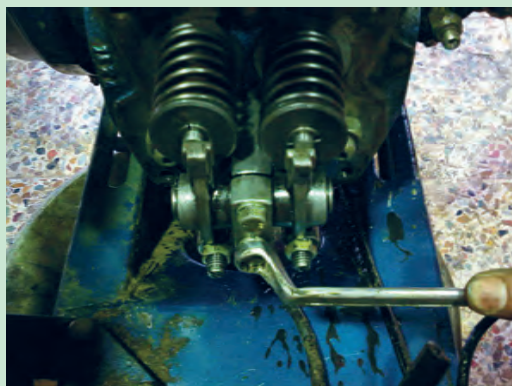
شکل ۵۴. باز کردن مجموعه اسبک‌ها
