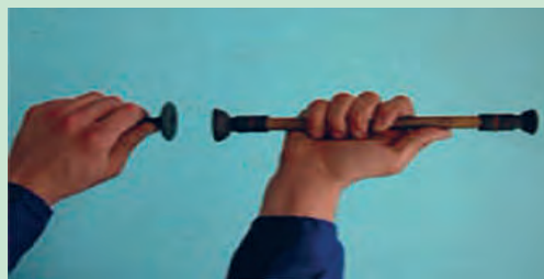
شکل ۷۷. اتصال سوپاپ به چوب سوپاپ گردان
