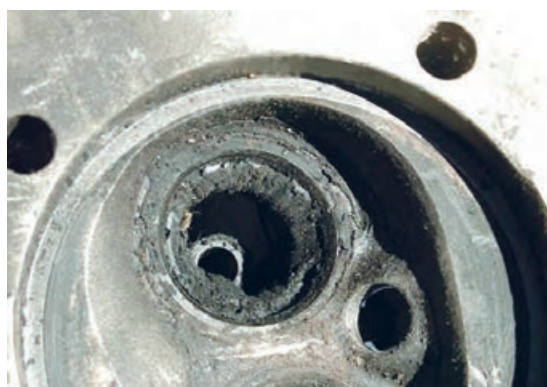
شکل ۶۷. کربن گرفتگی سرسیلندر و سوپاپ‌ها
