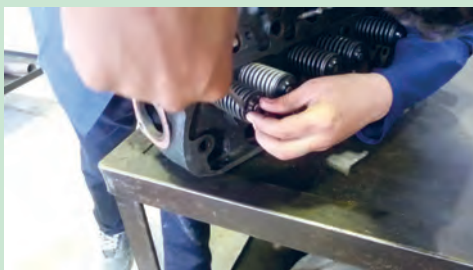
شکل ۵۷. خارج کردن لاستیک آببندی سوپاپ
