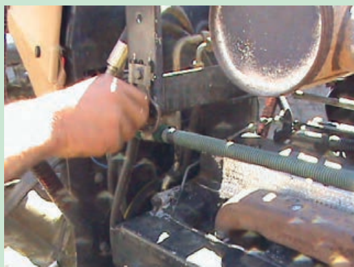
شکل ۴۱- باز کردن انباره اگزوز تراکتور MF۳۹۹
