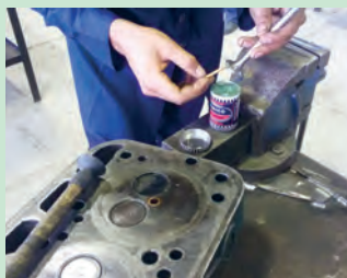
شکل ۷۸. زدن روغن سنباده به سوپاپها
