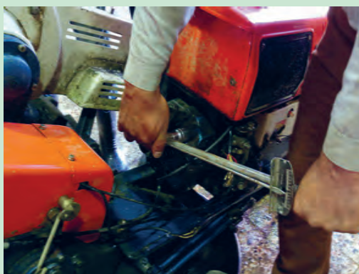
شکل ۵۵. باز کردن سر سیلندر
