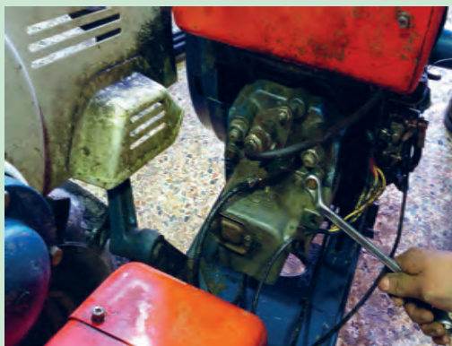
شکل ۵۳. باز کردن درپوش سوپاپ‌ها
