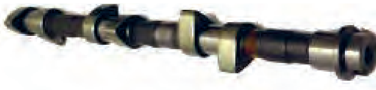
شکل ۲۱. میل بادامک (میل سوپاپ)
