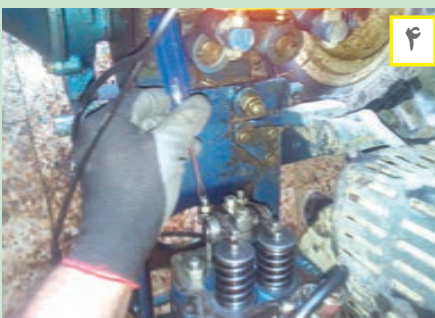
شکل ۳۷. فیلرگیری موتور تراکتور دوچرخ
