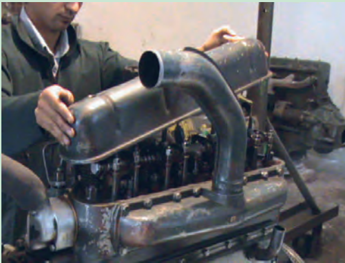
شکل ۴۴. برداشتن درپوش سوپاپ‌های تراکتور U650
