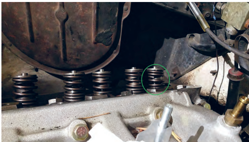
شکل ۷۱. شکستن فنر سوپاپ
