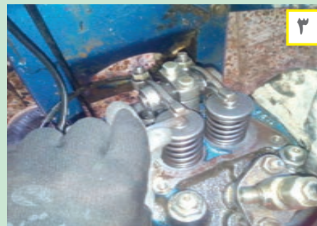
شکل ۳۷. فیلرگیری موتور تراکتور دوچرخ
