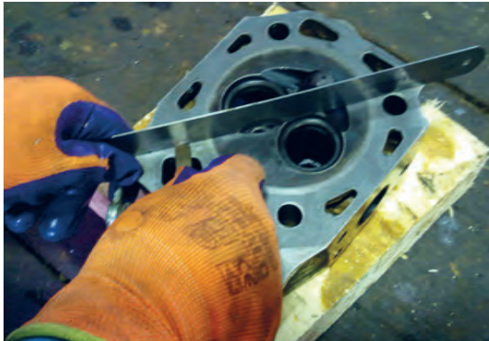
شکل ۶۵. کنترل تابیدگی سرسیلندر تراکتور دوچرخ
