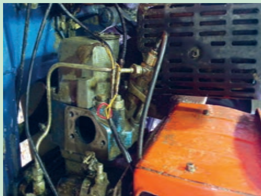
شکل ۵۲. باز کردن مانیفولد هوا
