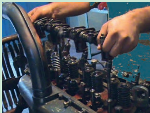
شکل ۴۶. برداشتن مجموعه اسبک از روی سرسیلندر
