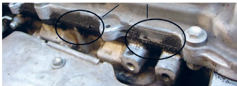
شکل ۲۷. نشستی روغن از درپوش سوپاپ‌ها
