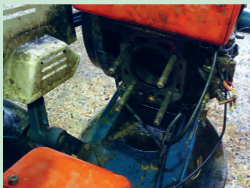
شکل ۵۶. برداشتن سر سیلندر
