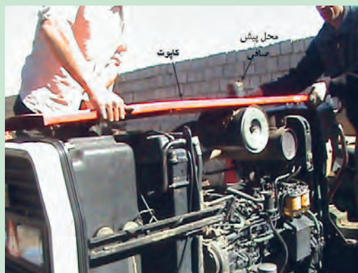
شکل ۴۰. برداشتن کاپوت تراکتور MF۳۹۹
