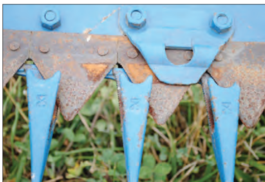
شکل ۱۰- موقعیت انگشتی و تیغه در دروگر شانه‌ای
