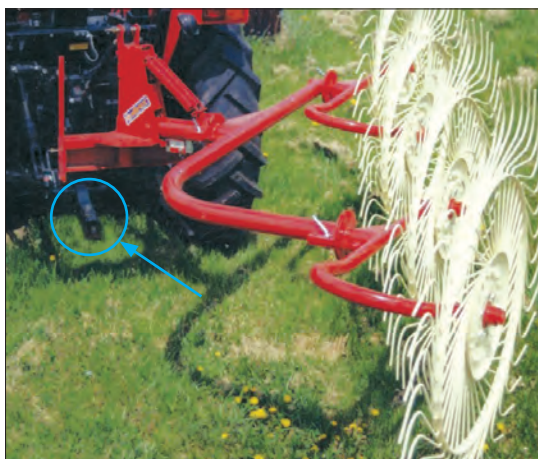
شکل ۵۹- اتصال شانه خورشیدی به تراکتور
