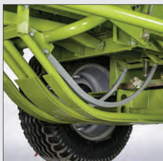
شکل ۹۱- مسیر نخ کردن بسته‌بند و جایگاه سوزن
