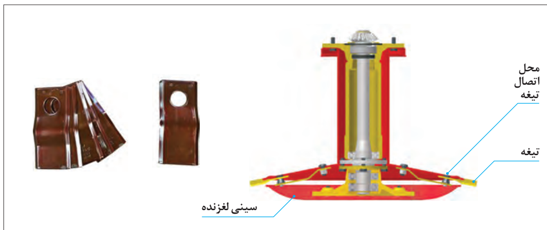
شکل ۴- تیغه و محل قرارگیری آن روی استوانه
