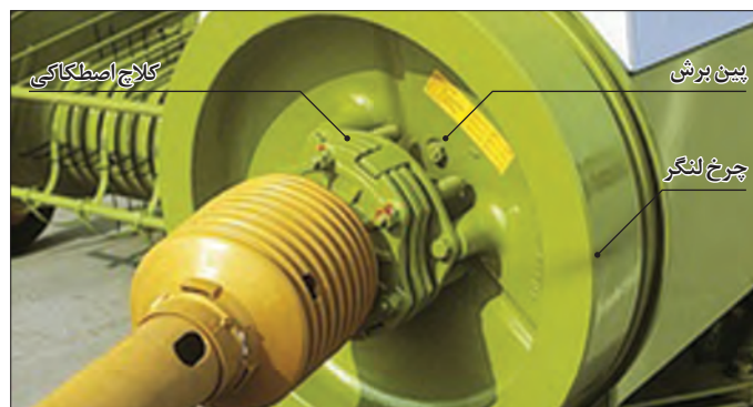
شکل ۸۰- چرخ لنگر و کلاچ ایمنی
