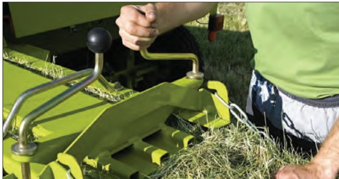
شکل ۱۰۱- تیرک‌های فشاردهنده و تنظیم آن
