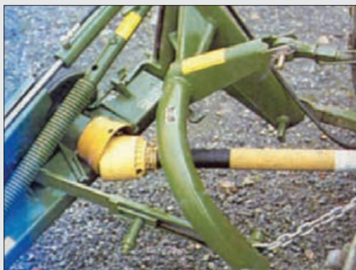
شکل ۲۶- نقاط اتصال دروگر بشقابی و زنجیر تثبیت ارتفاع
