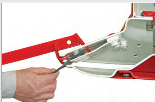
شکل ۲۲- شکل شماتیک از تعویض تیغه دروگر استوانه‌ای
