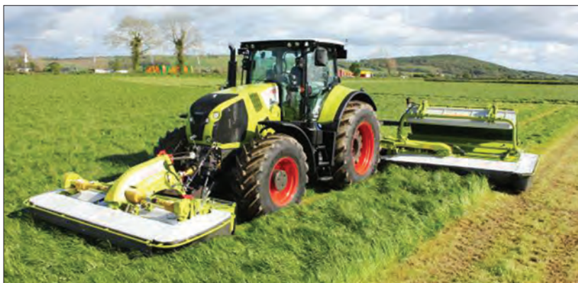
شکل ۲۵- دروگرهای عقب سوار و جلو سوار متصل به تراکتور
