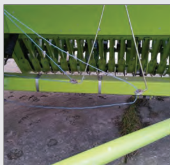
شکل ۹۱- مسیر نخ کردن بسته‌بند و جایگاه سوزن
