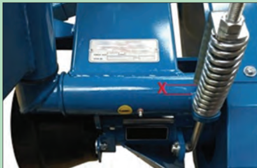
شکل ۲۱- شاخص تنظیم کشش تسمه دروگر استوانه‌ای
