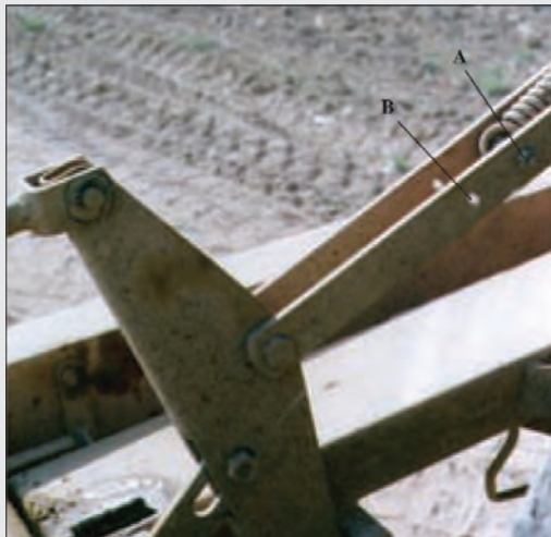
شکل ۳۷- تنظیم فنر شناور
