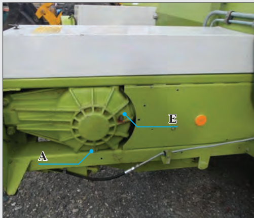
شکل ۱۱۱- درپوش تخلیه و بازدید روغن جعبه‌دنده بسته‌بند
