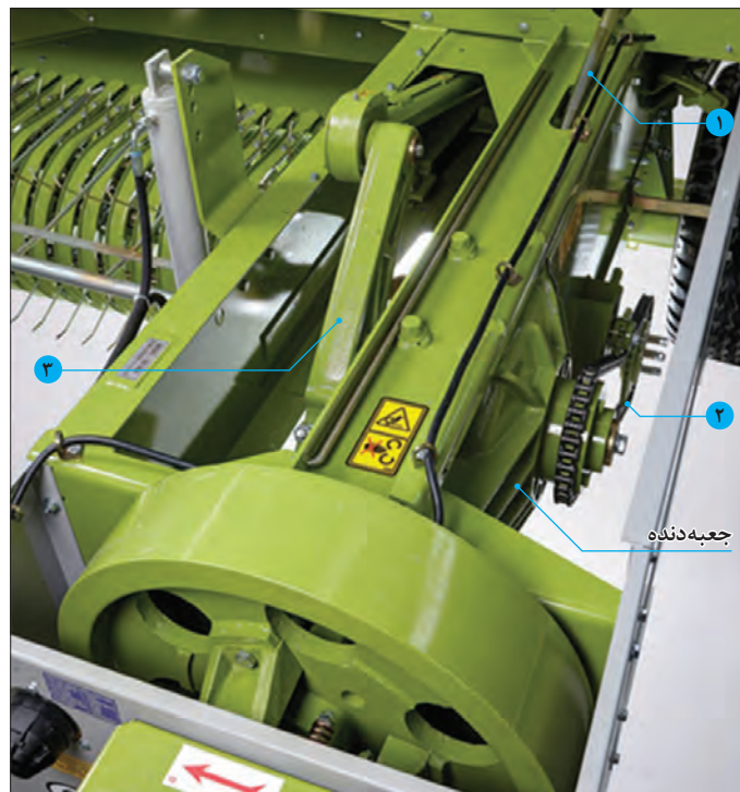
شکل ۸۲- مسیر انتقال توان در بسته‌بند
