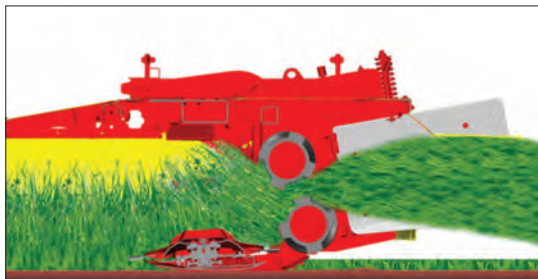
شکل ۵۶- دروساقه کوب و طرز کار آن
