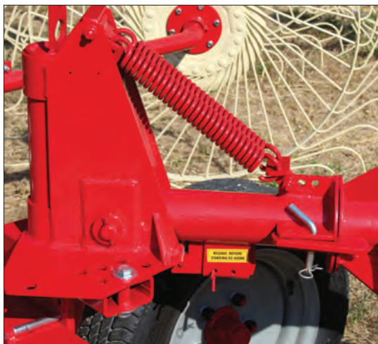
شکل ۶۰- فنرهای شناوری شانه خورشیدی
