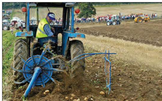
شکل ۹- سیب‌زمینی‌کن دوار در حال کار
