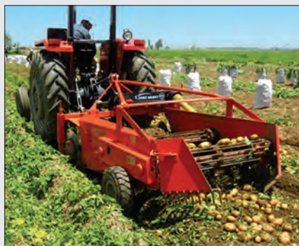
شکل ۱۷- برداشت سیب‌زمینی با سیب‌زمینی‌کن نقاله‌ای
