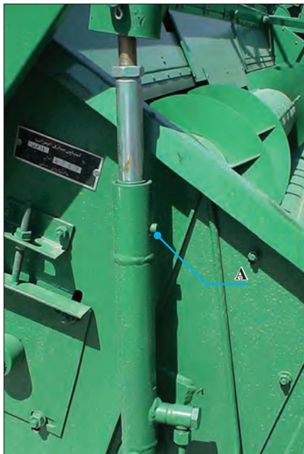
شکل ۴۲- جک هیدرولیک تنظیم ارتفاع چرخ و فلک
