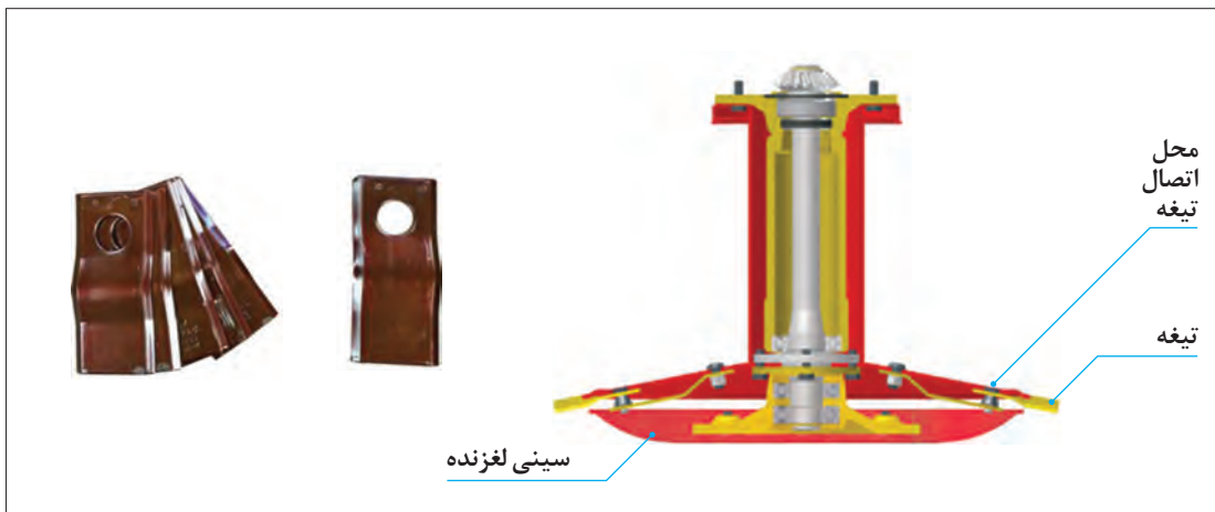
شکل ۴- تیغه و محل قرارگیری آن روی استوانه
