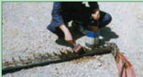
شکل ۵۰- تمیز کردن شانه برش با گازوئیل
