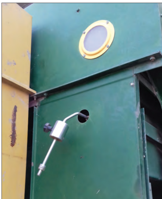
شکل ۳۳- وزنه تنظیم ضربه زن غربال بالایی
