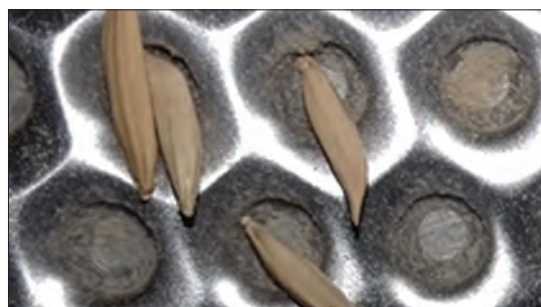
شکل ۱۶- قرار گرفتن دانه‌ها در سوراخ‌های استوانه حفره‌دار
