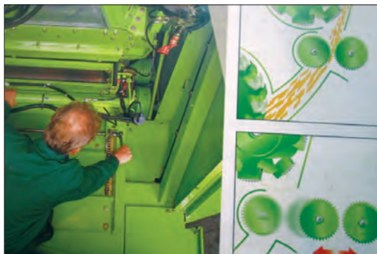
شکل ۲۱- خارج کردن بلال خردکن از مدار
