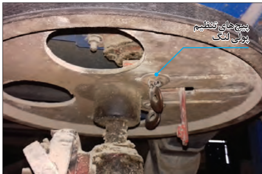
شکل ۳۴- پیچ تنظیم کورس غربال کابلی
