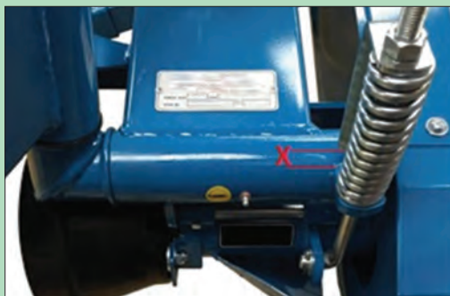
شکل ۲۱- شاخص تنظیم کشش تسمه دروگر استوانه‌ای
