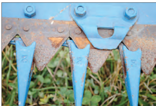
شکل ۱۰- موقعیت انگشتی و تیغه در دروگر شانه‌ای
