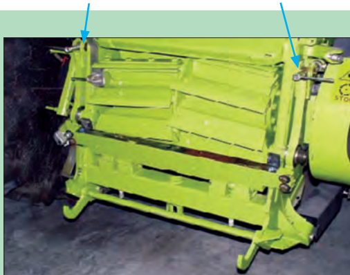
شکل ۲۸- اهرم‌های تنظیم تیغه ثابت در چاپر خودگردان
