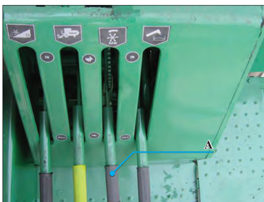
شکل ۳۹- اهرم تنظیم سرعت پروانه چرخ و فلک
