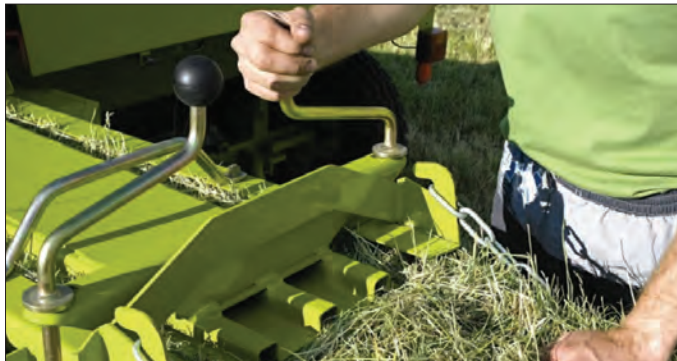
شکل ۱۰۱- تیرک‌های فشاردهنده و تنظیم آن
