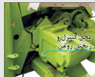
شکل ۴۵- جعبه دنده باردهی غلتک‌های تغذیه
