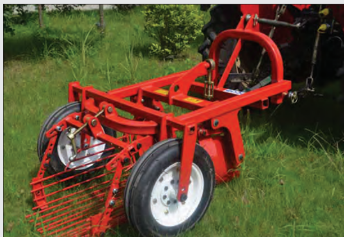
شکل ۱۳- اتصال سیب زمینی کن لرزان به تراکتور
