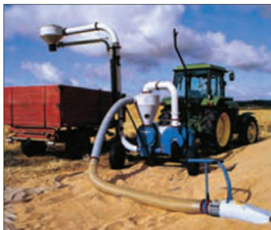
شکل ۲۹- نقاله بادی و طرز کار آن
