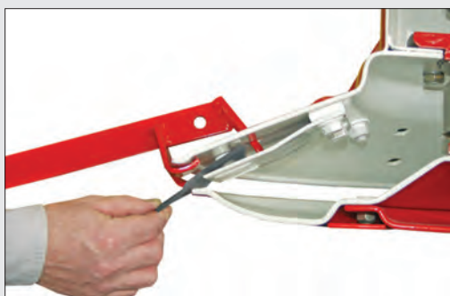
شکل ۲۲- شکل شماتیک از تعویض تیغه دروگر استوانه‌ای
