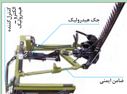
شکل ۱۷- دروگر شانه‌ای با سیستم محرک ارتعاشی
