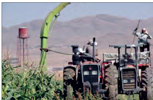
شکل ۳۲- تناسب لوله تخلیه با ماشین حمل
