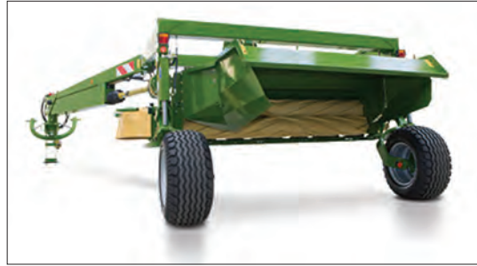
شکل ۵۵- ساقه کوب و طرز کار غلتک‌های آن
