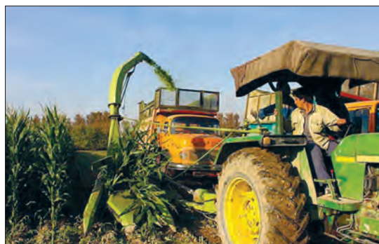
شکل ۳۲- تناسب لوله تخلیه با ماشین حمل
