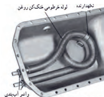
الف- عبور لوله مایع خنک‌کننده از کارتر ب- عبور مایع خنک‌کننده از پایه فیلتر JD۳۱۴ ج- رادیاتور روغن U۶۵ شکل ۴۶. انواع خنک‌کن روغن رایج در تراکتورها
