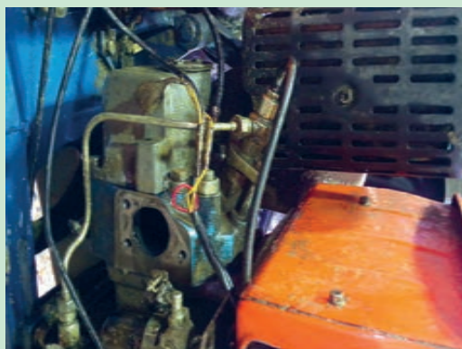
شکل ۵۲. باز کردن مانیفولد هوا
