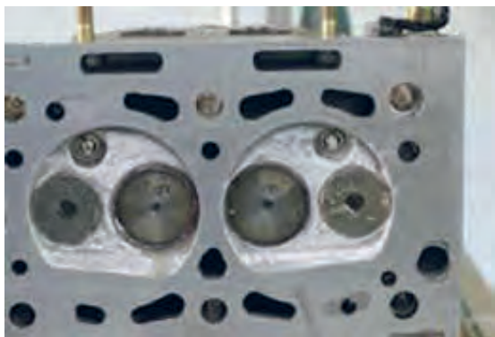
شکل ۷۴. ریختن نفت در سرسیلندر برای کنترل آب‌بندی سوپاپ‌ها
