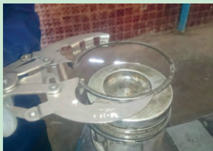
شکل ۵۲. نحوه خارج کردن رینگ از روی پیستون
