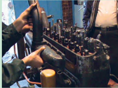
شکل ۴۳. باز کردن مانیفولد تراکتور U650
