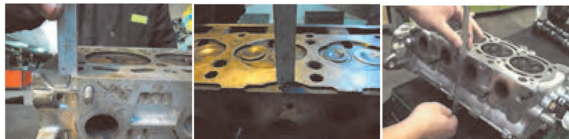
شکل ۸۳. کنترل ارتفاع مجاز کف تراشی سر سیلندر
