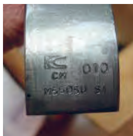
شکل ۲۳. تغییر ضخامت یاتاقان در سایزهای مختلف
