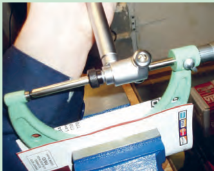
شکل ۷۶. اندازه‌گیری قطر سیلندر با میکرومتر داخلی
