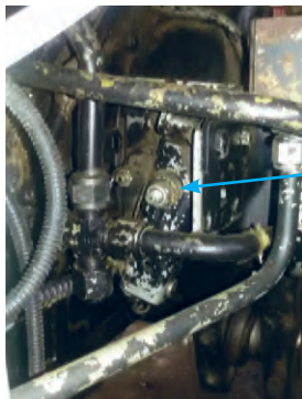
شکل ۱۰. پیچ هواگیری تراکتور MF۳۹۹
