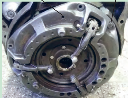
شکل ۲۵. جدا کردن مجموعه کلاچ از فلاپویل
