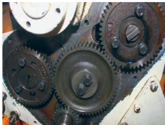
شکل ۲۷. چرخ دنده‌های تایمینگ در سینی جلو موتور
