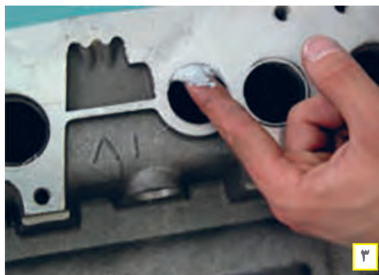
شکل ۶۹. روش تعویض پولک سر سیلندر
