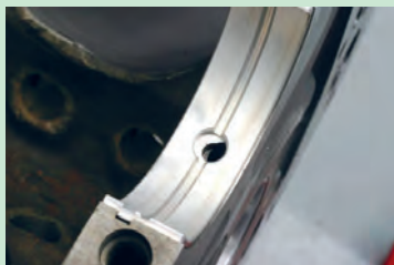
شکل ۹۳. قرار گرفتن سوراخ روغن مقابل هم
