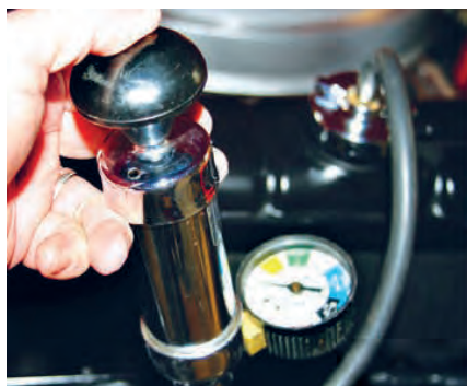
شکل ۶. آزمایش نشت یابی تحت فشار
