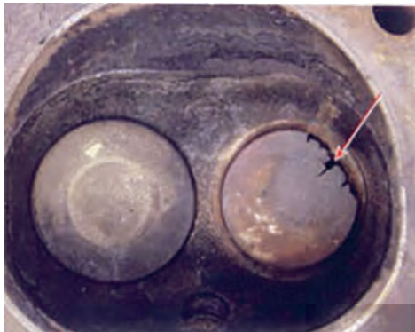
شکل ۷۰. عیوب ظاهری سوپاپ‌ها
