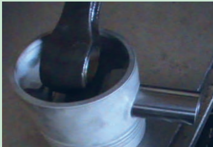
شکل ۵۴. خارج کردن گژن پین و جدا کردن پیستون
