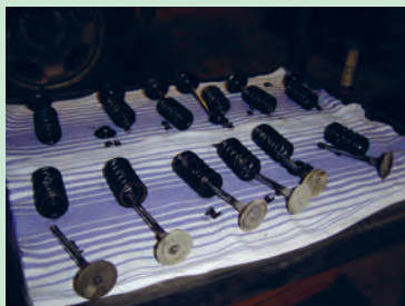
شکل ۵۹. چیدن اجزای سوپاپ به ترتیب باز شدن
