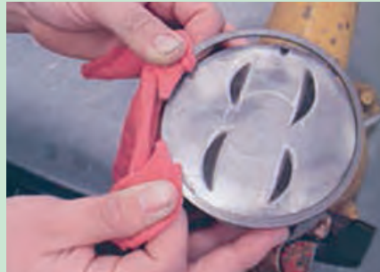
شکل ۵۳. خارج کردن رینگ بدون رینگ بازکن
