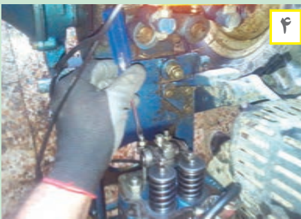
شکل ۳۷. فیلرگیری موتور تراکتور دوچرخ
