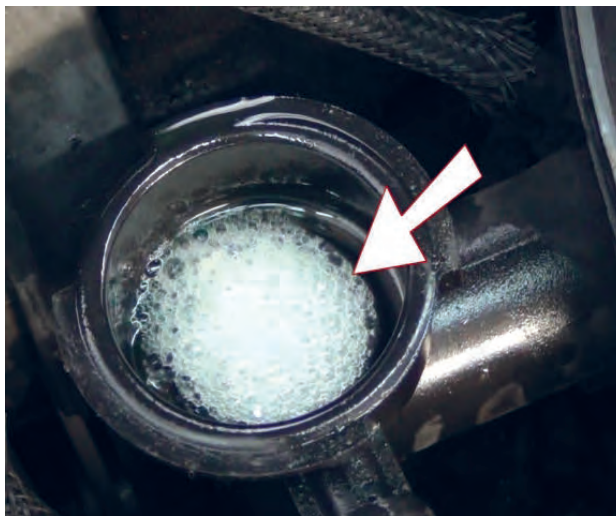
شکل ۳۳. خروج حباب از رادیاتور
