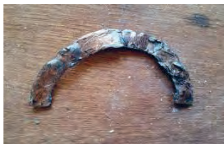
شکل ۷۳. نمونه بغل یاتاقانی معیوب
