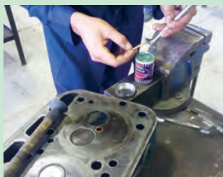
شکل ۷۸. زدن روغن سنباده به سوپاپها
