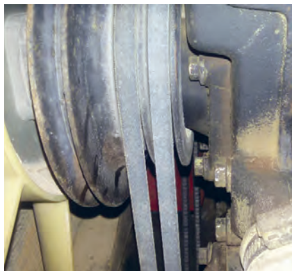
شکل ۷. استفاده از دو تسمه در تراکتور MF399
