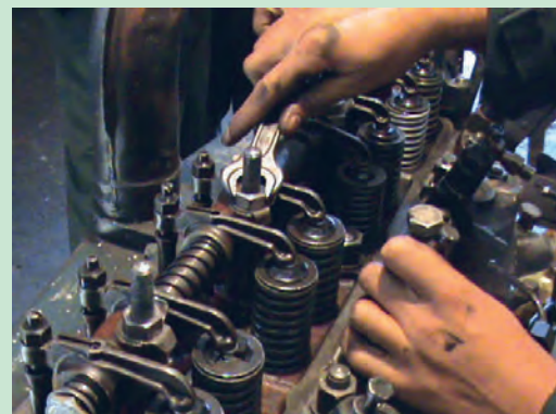
شکل ۴۵. باز کردن پیچ‌های پایه اسبک
