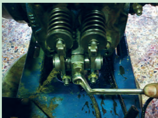
شکل ۵۴. باز کردن مجموعه اسبک‌ها
