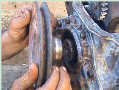
شکل ۳۵. پیاده کردن پولی میل لنگ
