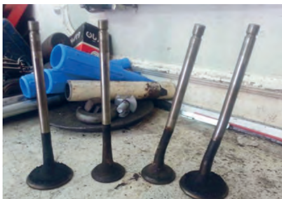
شکل ۶۷. کربن گرفتگی سرسیلندر و سوپاپ‌ها
