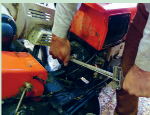
شکل ۵۵. باز کردن سر سیلندر
