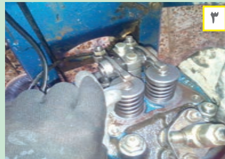
شکل ۳۷. فیلرگیری موتور تراکتور دوچرخ
