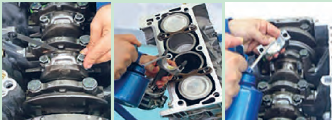
شکل ۱۰۲. کنترل لقی شاتون روی محور میل لنگ
