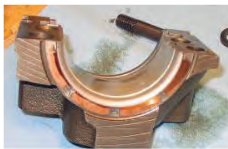
شکل ۷۳. نمونه بغل یاتاقانی معیوب
