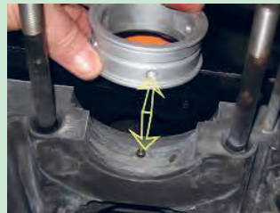
شکل ۹۳. قرار گرفتن سوراخ روغن مقابل هم
