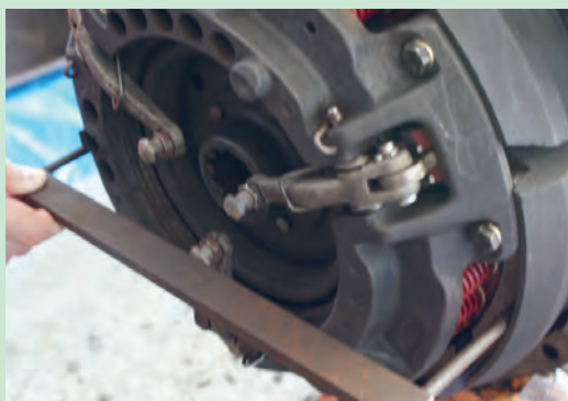
شکل ۳۸. تنظیم انگشتی‌های کلاچ
