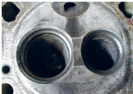
شکل ۶۶. ترک خوردگی سرسیلندر در محفظه احتراق
