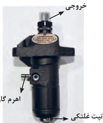
شکل ۲۷. پمپ انژکتور واحدی و موقعیت آن روی تراکتور باغی با موتور لمباردینی
