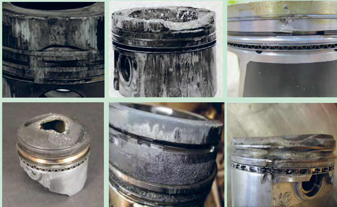
شکل ۷۴. نمونه ای از پیستون های معیوب
