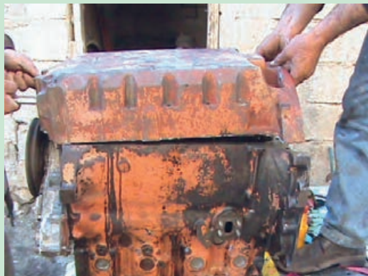
شکل ۱۱۵. نصب کارتر روی بلوکه سیلندر
