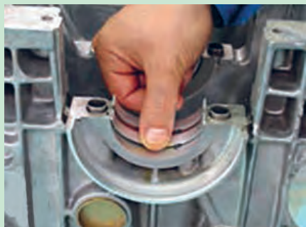
شکل ۵۰. برداشتن یاتاقان های ثابت و بغل یاتاقانی
