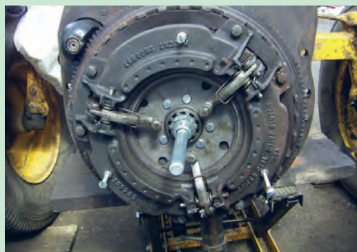
شکل ۳۷. سوار کردن مجموعه کلاچ روی فلاپیول
