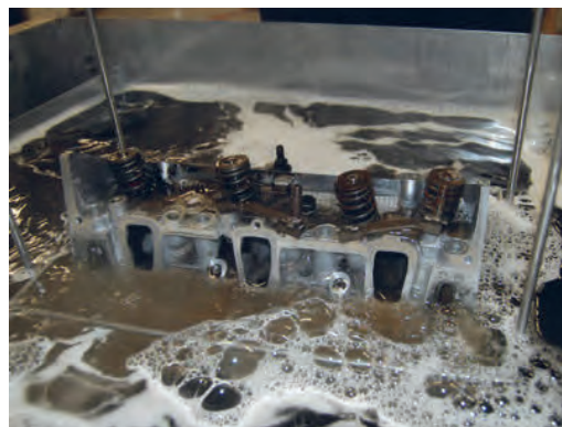
شکل ۶۲. شستشوی سرسیلندر به روش غوطه‌وری در وان شستشو
