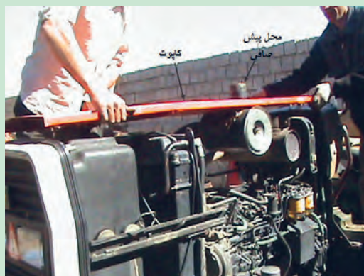
شکل ۴۰. برداشتن کاپوت تراکتور MF۳۹۹
