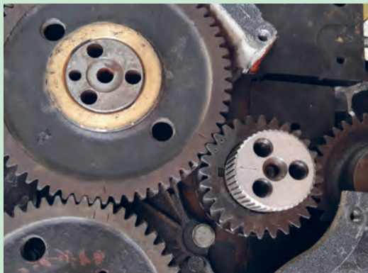
شکل ۱۰۹. علامت‌های تایمینگ روی چرخ دنده ها
