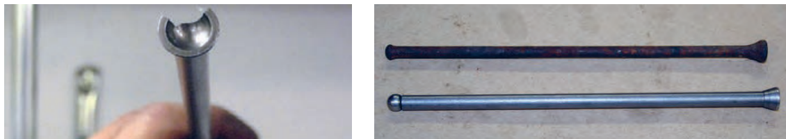
شکل ۷۶. زنگ زدن و شکستگی میل تپت
