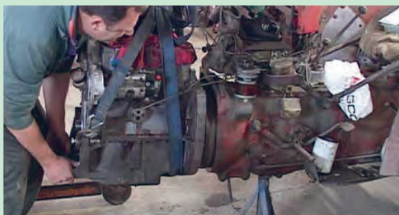
شکل ۳۲. جدا کردن موتور از جعبه دنده
