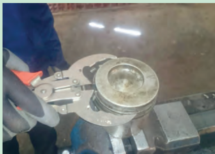
شکل ۵۲. نحوه خارج کردن رینگ از روی پیستون
