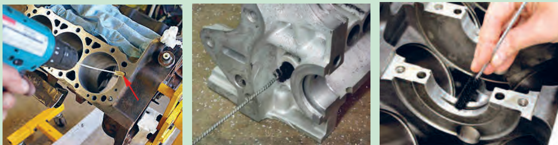
شکل ۵۹. تمیز کردن مجاری آب و روغن
