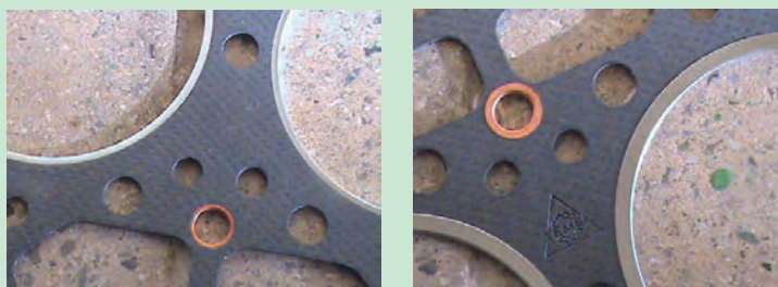
شکل ۸۷. تفاوت ضخامت قسمت‌های مسی روی واشر سرسیلندر
