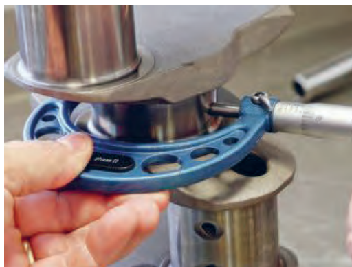
شکل ۷۱. اندازه‌گیری قطر میل‌لنگ
