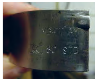
شکل ۲۳. تغییر ضخامت یاتاقان در سایزهای مختلف
