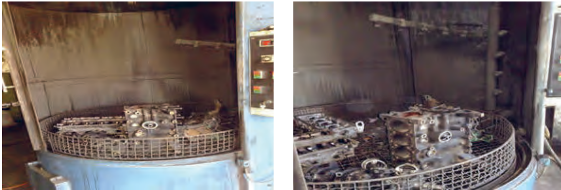
شکل ۶۱. شستشوی موتور به وسیله دستگاه شات بلاست
