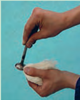
شکل ۸۰. تمیز کردن سوپاپ
