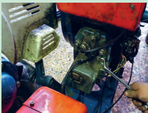
شکل ۵۳. باز کردن درپوش سوپاپ‌ها
