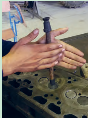
شکل ۷۹. چرخاندن سوپاپ به وسیله چوب سوپاپ گردان
