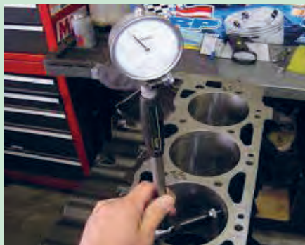
شکل ۷۶. اندازه‌گیری قطر سیلندر با میکرومتر داخلی
