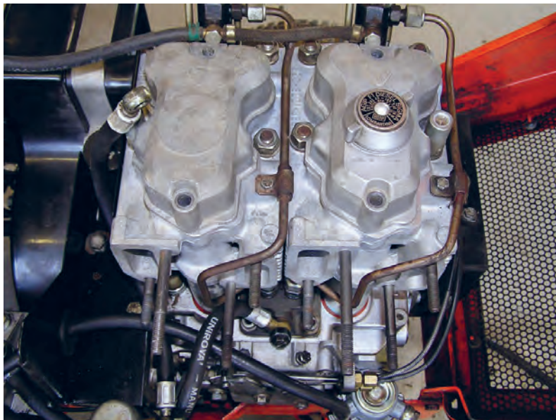
شکل ۱۲. دو سرسیلندر مجزا در موتور لومباردینی به کار رفته در تراکتورهای باگی
