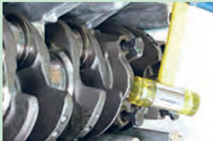
شکل ۴۷. شل کردن کپه های یاتاقان
