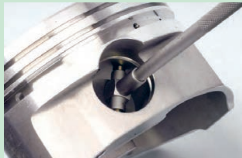
شکل ۸۱. اندازه گیری لقی گزن بین در پیستون
