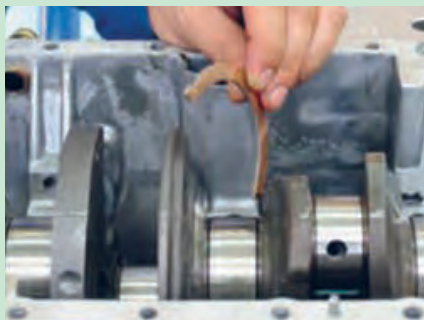
شکل ۵۰. برداشتن یاتاقان های ثابت و بغل یاتاقانی
