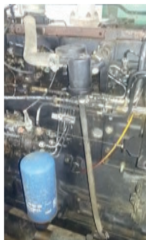
شکل ۳۹. تهویه محفظه کارت‌تر در تراکتور MF399
