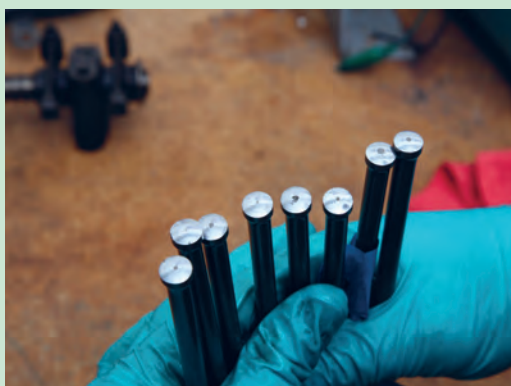
شکل ۴۷. خارج کردن میل تپت‌ها
