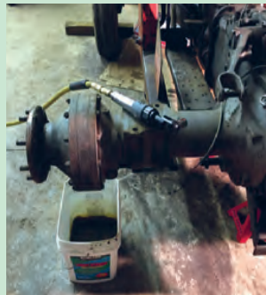
شکل ۳۲. کاهنده نهایی بعد از باز کردن چرخ
