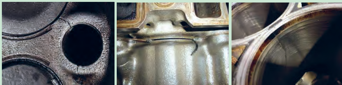
شکل ۶۲. ترک در سیلندر و بلوکه سیلندر
