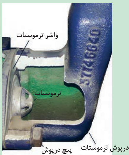
شکل ۱۷. نمای برش خورده ترموستات تراکتور MF۲۸۵
