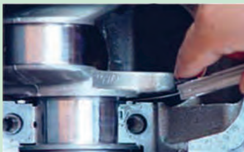
شکل ۸۸. اندازه گیری لقی طولی میل لنگ با ساعت اندازه گیر و فیلر تیغه ای
