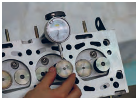
شکل ۷۳. روش کنترل لقی بین سوپاپ و گیت
