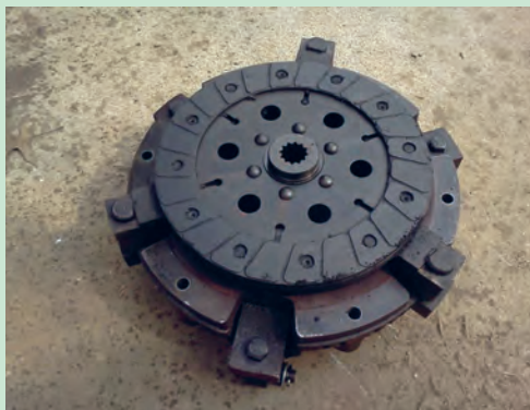
شکل ۲۵. جدا کردن مجموعه کلاچ از فلاپویل
