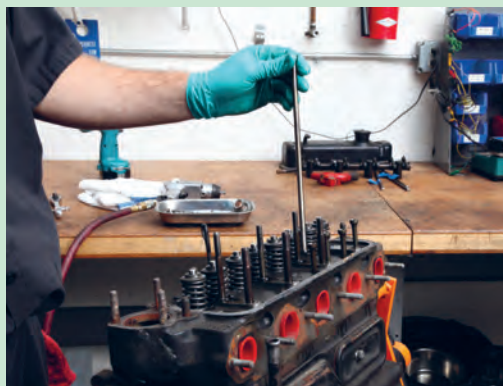
شکل ۴۷. خارج کردن میل تپت‌ها
