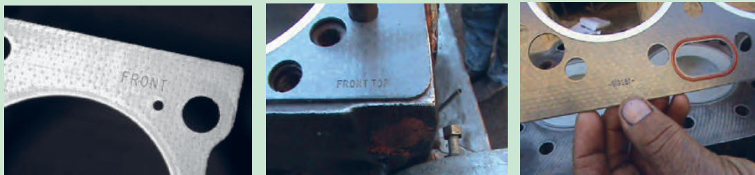
شکل ۸۶. علامت‌های روی واشر سرسیلندر
