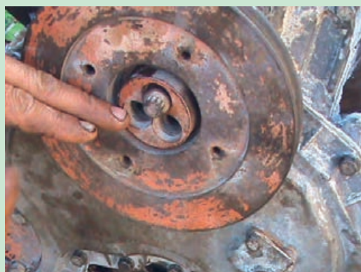
شکل ۱۱۳. پیچ های پولی سر میل لنگ
