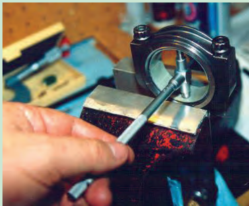
شکل ۸۳. کنترل بیضی شدن سر بزرگ شاتون
