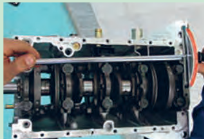
شکل ۴۶. باز کردن پیچ های یاتاقان
