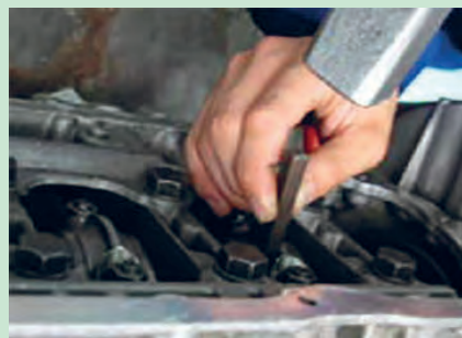
شکل ۴۱. علامت زدن کپه شاتون
