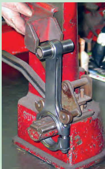
شکل ۸۲. پیچیدگی شاتون، اندازه گیری و اصلاح آن
