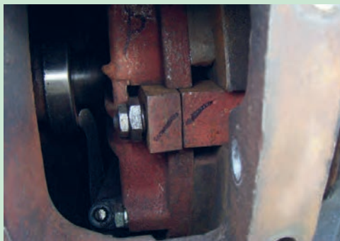
شکل ۲۶. علامتگذاری قطعات مجموعه کلاچ
