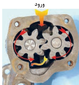
شکل ۴۲. پمپ روغن دنده ای
