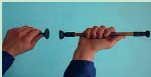
شکل ۷۷. اتصال سوپاپ به چوب سوپاپ گردان
