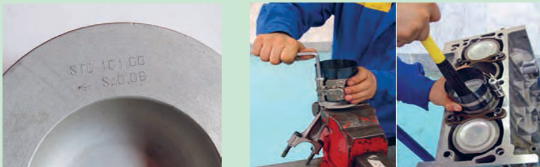
شکل ۹۹. وارد کردن پیستون به داخل سیلندر شکل ۱۰۰. علامت روی پیستون
